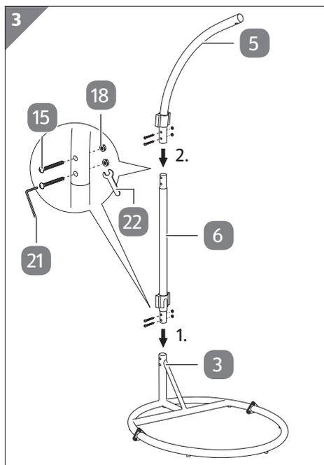
1. Stecken Sie die Stange **6** in den Standfuß **3** und befestigen Sie sie mit zwei Schrauben M8\*55 **15** und zwei großen Muttern **18** (siehe Schritt 1).
