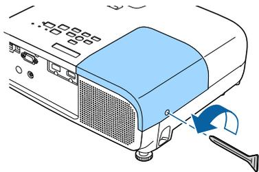
**3** Entfernen Sie die Lampenabdeckung. Schieben Sie die Lampenabdeckung gerade nach vorne ab.
