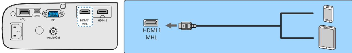
Das angeschlossene Smartphone oder Tablet beginnt mit dem Aufladen, wenn Bilder projiziert werden.
