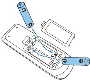
**3** Setzen Sie den Batteriefachdeckel wieder ein.
