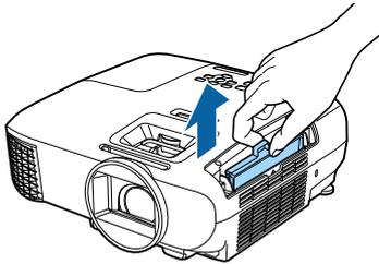
3 Halten Sie den Luftfilter mit der Oberfläche nach unten und entfernen Sie den Staub durch vier- bis fünfmaliges Ausklopfen.
