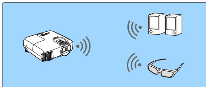
Per HDMI1-Anschluss, HDMI2-Anschluss oder Screen Mirroring eingehender Ton wird über Lautsprecher oder Kopfhörer mit Bluetooth-Unterstützung ausgegeben.
