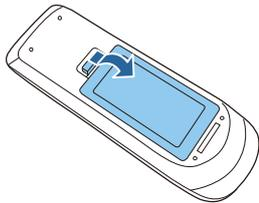
**2** Ersetzen Sie die alten Batterien durch neue.
