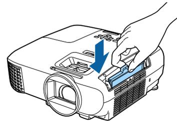
6 Schließen Sie die Abdeckung des Luftfilters.
