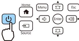
Die Betriebsanzeige blinkt blau, während sich der Projektor aufwärmt. Sobald der Projektor aufgewärmt ist, blinkt die Betriebsanzeige nicht mehr und leuchtet blau.
