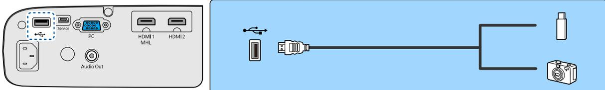
Mit angeschlossenem USB-Gerät können Sie Bilddateien von einem USB-Speichermedium oder einer Digitalkamera aus als Präsentation projizieren. [S.52](#)
