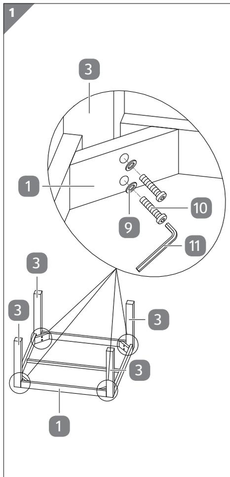
1. Verbinden Sie die vier Tischbeine **3** mit dem Tischgestell **1**. Drehen Sie hierzu das Tischgestell um und stellen Sie sicher, dass die Seite mit den Saugnäpfen nach unten zeigt. Achten Sie darauf, dass die vorgebohrten Löcher des Tischgestells und der Tischbeine jeweils übereinander liegen. Verwenden Sie jeweils zwei Schrauben **10** und zwei Unterlegscheiben **9**, um die Tischbeine zu montieren.
