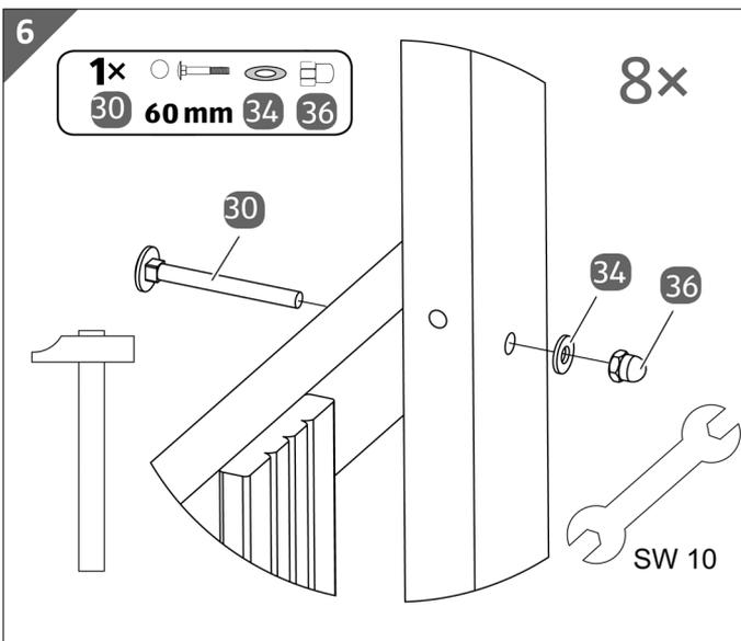
1. Montieren Sie einen Standpfosten für das Rad **12** und den Standpfosten vorne (6 Bohrungen) **13** mithilfe der M6 Torbandschrauben (60mm) **30**, der kleinen Unterlegscheiben **34** und der M6 Hutmuttern **36** an die Querleisten der Seitenwand **11**.
