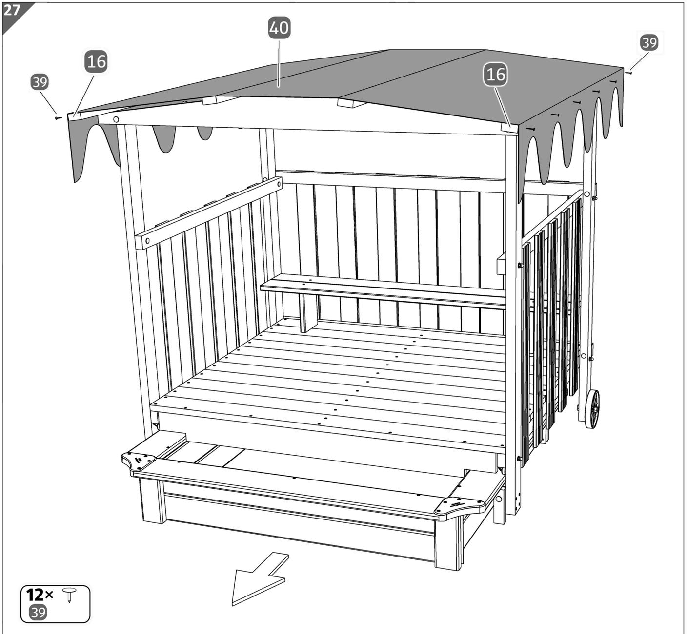
15. Fixieren Sie die Dachfolie **40** mithilfe der Dachpappnägel **39** an den äußeren Firstlatten **16**.
