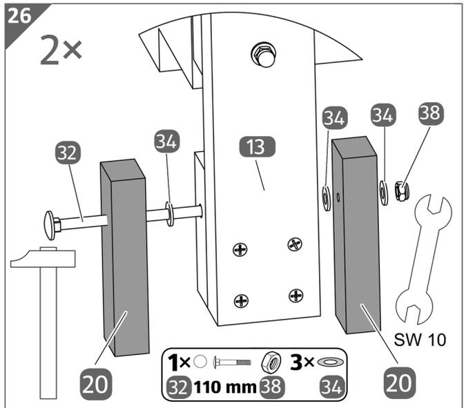
14. Montieren Sie die Sicherungsriegel **20** mit der M6 Torbandschraube (110 mm) **32**, den Unterlegscheiben **34** und der M6 Sicherungsmutter **38** links und rechts vom Sicherungsbasisteil.
