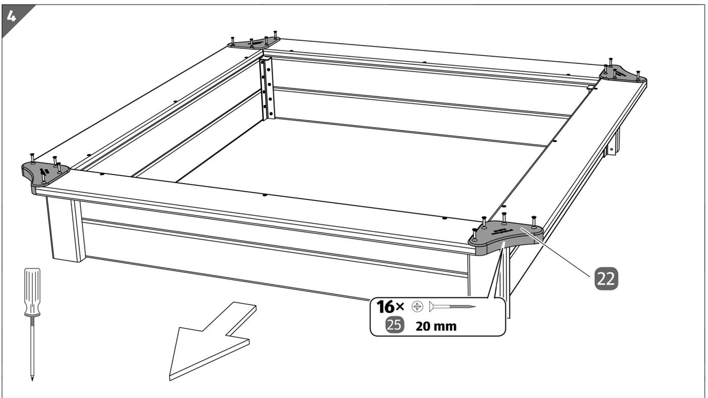
2. Schrauben Sie die vier Schutzecken **22** mithilfe der Spanplattenschrauben (20mm) **25** zwischen die Sitzbretter.
