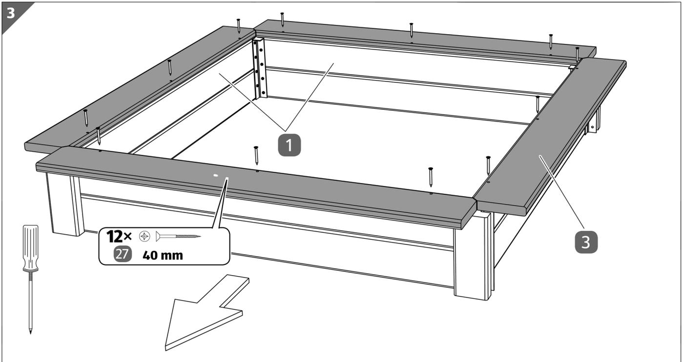
1. Montieren Sie die vier Sitzbretter **3** mithilfe der Spanplattenschrauben (40 mm) **27** auf die Seitenbretter **1**.
