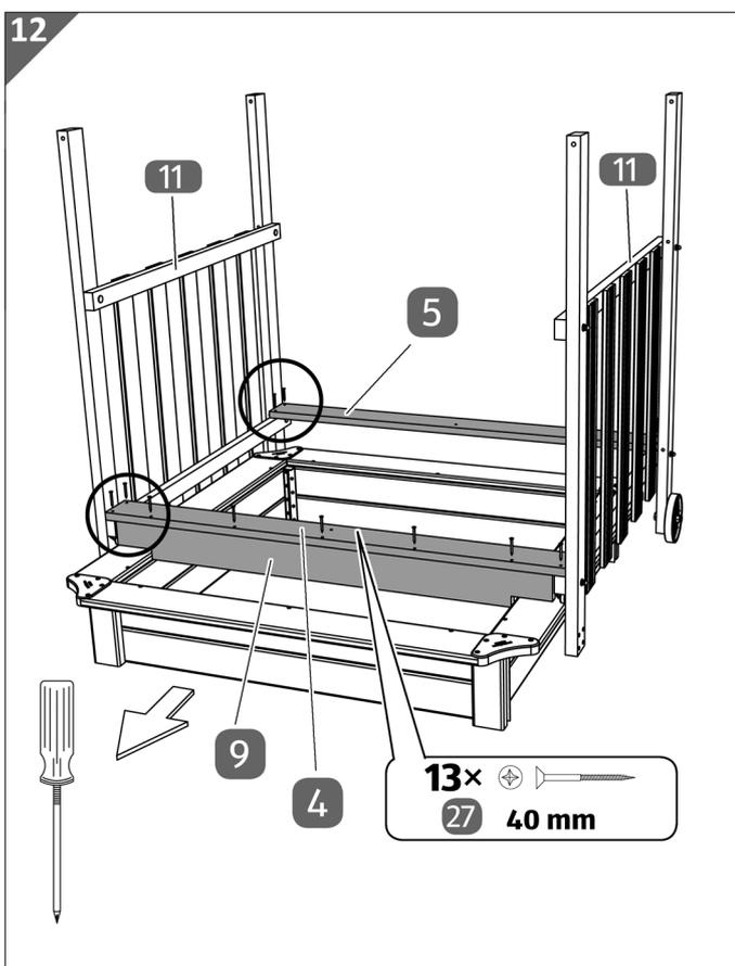
2. Fixieren Sie die beiden Seitenwände mithilfe der beiden Bodenbretter **4** und **5**. Montieren Sie hierzu das vordere Bodenbrett und das hintere Bodenbrett mithilfe der Spanplattenschrauben (40 mm) **27** an den Seitenwänden.
