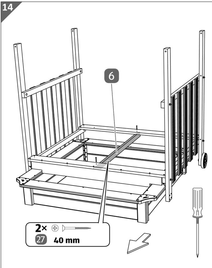
4. Montieren Sie die Stützleiste **6** mithilfe der Spanplattenschrauben (40 mm) unter dem vorderen und dem hinteren Bodenbrett.
