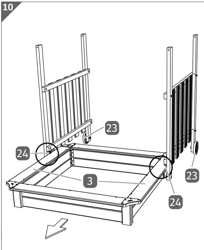
1. Stellen Sie die beiden Seitenwände **11** so an den Sandkasten, dass die Führungsrolle **24** jeweils auf dem Sitzbrett **3** aufliegt.
