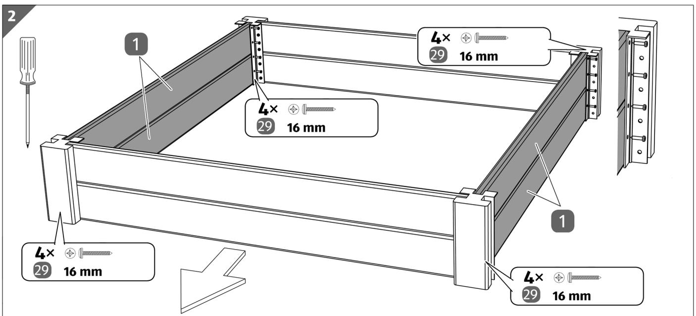
3. Verbinden Sie mithilfe der Rundkopfschrauben (16 mm) und den Seitenbrettern die zwei Elemente miteinander.
