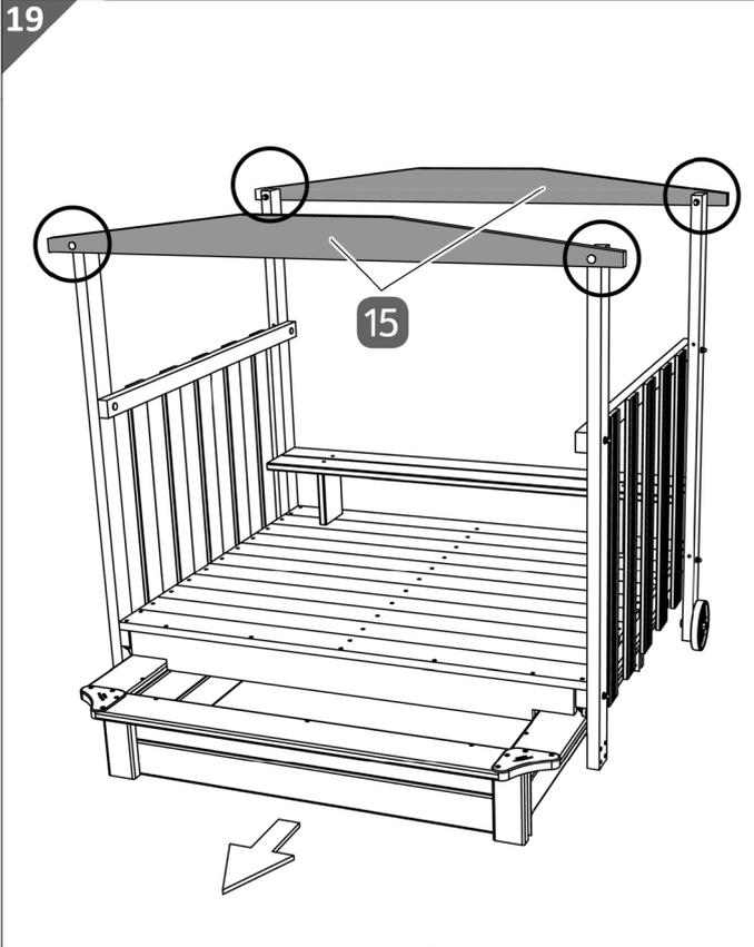
9. Montieren Sie mithilfe der M6 Torbandschrauben (90 mm) **31**, der kleinen Unterlegscheiben **34** und der M6 Hutmutter **36** die Giebelbretter **15**.
