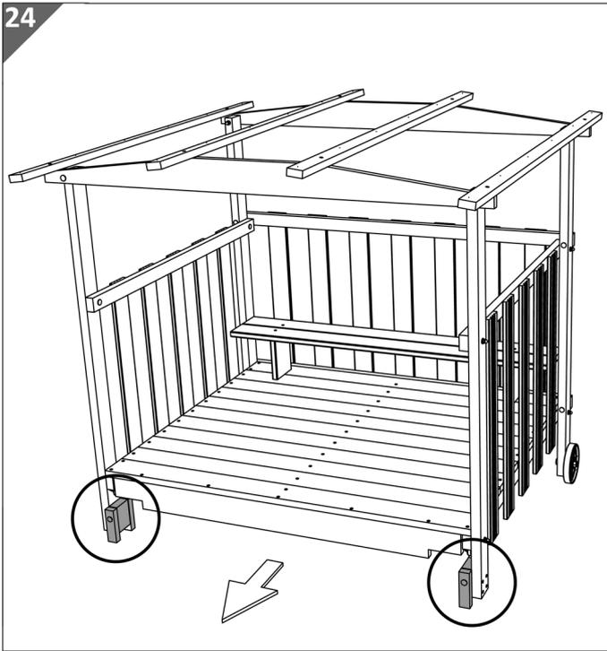
12. Befestigen Sie an den beiden Seitenwänden die Arretierungen, bestehen aus Sicherungsbasisteil **18** und Sicherungsriegel **20**.
