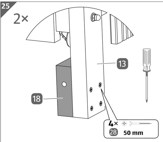
13. Montieren Sie das Sicherungsbasisteil **18** mit den Spanplattenschrauben (50 mm) **28** an den vorderen Standpfosten **13**.
