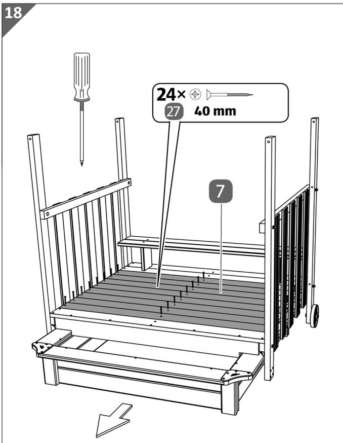
8. Montieren Sie mithilfe der Spanplattenschrauben (40mm) **27** die acht Bodenbretter (3 Bohrungen) **7**.
