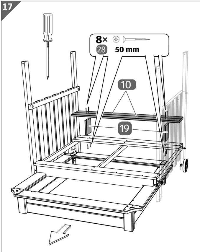
6. Montieren Sie die beiden Bankfüße **19**, indem Sie die Spanplattenschrauben (50mm) **28** von unten durch die in den Bodenbretter vorgebohrten Öffnungen führen und sie anschließend in das Holz der Bankfüße drehen.
