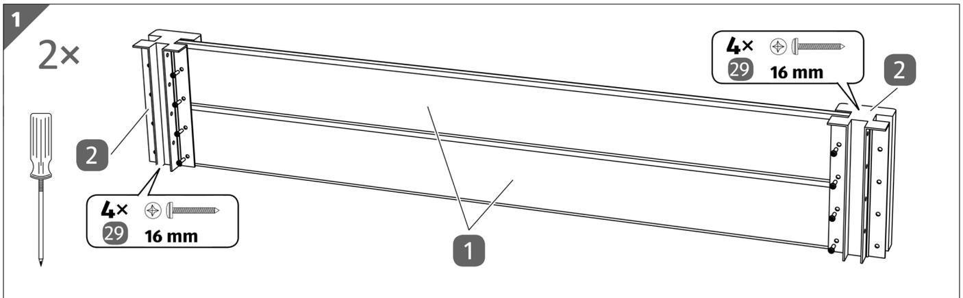
1. Verbinden Sie mithilfe der Rundkopfschrauben (16 mm) (29) je 2 Seitenbretter (1) mit 2 Eckfüßen (2).
