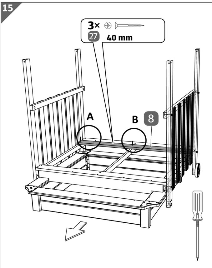
5. Montieren Sie mithilfe der Spanplattenschrauben (40 mm) das Bodenbrett **8** mit den fünf Bohrungen.
