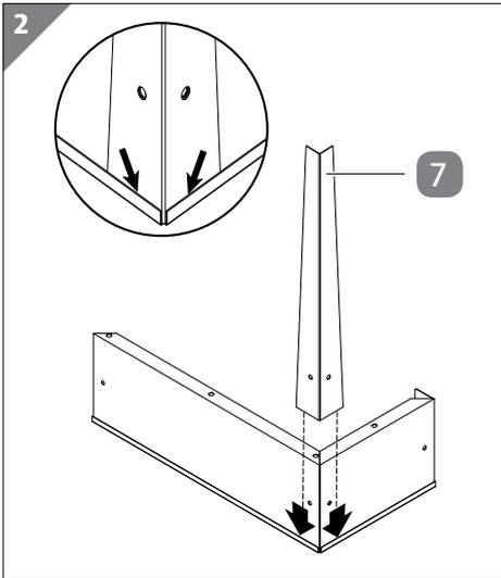
1. Fixieren Sie die Seitenteile, indem Sie ein Standbein **7** auf die Kante stecken. Achten Sie darauf, dass Sie dabei das Standbein in die Kerbe an den Seitenteilen führen.
