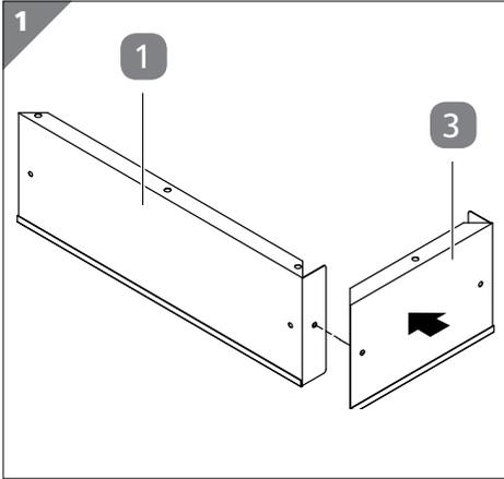
1. Bringen Sie die Bohrung eines kurzen Seitenteils **3** mit der Bohrung eines langen Seitenteils **1** wie abgebildet übereinander.
