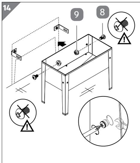
1. Schrauben Sie die abgebildeten zwei kurzen Schrauben **8** samt Muttern **9** für die Befestigung des Produkts ab.
