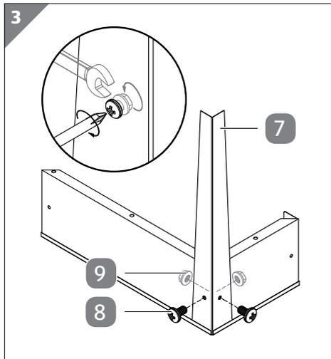
1. Schrauben Sie das Standbein **7** mit zwei kurzen Schrauben **8** und zwei Muttern **9** fest. Drehen Sie dabei mithilfe des Schraubenschlüssels **14** die Muttern und die Schrauben mit dem Kreuzschlitzschraubendreher **13** gegeneinander fest.
