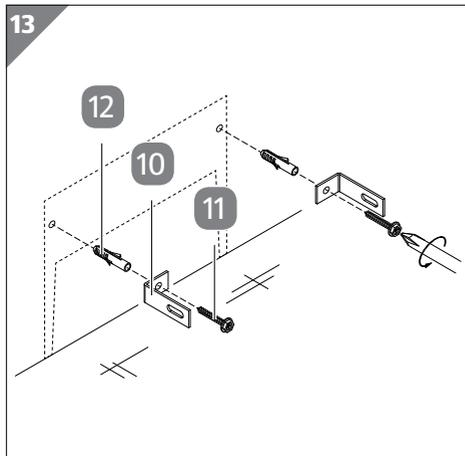
1. Stecken Sie die Dübel **12** in die Bohrlöcher.
