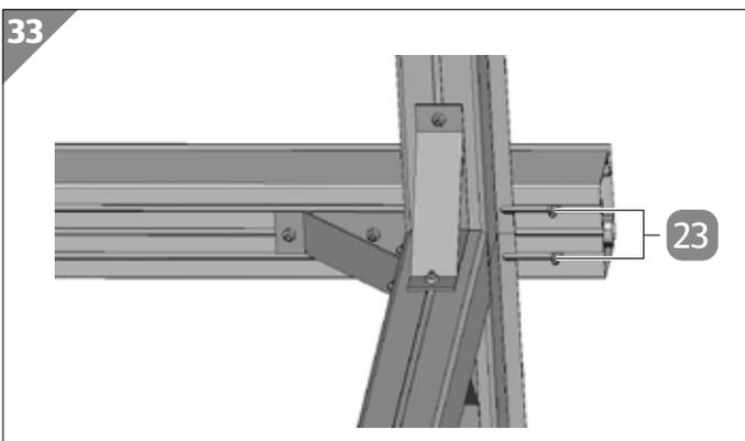
10. Setzen Sie auf beiden Seiten des Koppelträgers je eine M6×12-mm-Schraube **23** in die beiden äußeren Schraubenkanäle ein.
