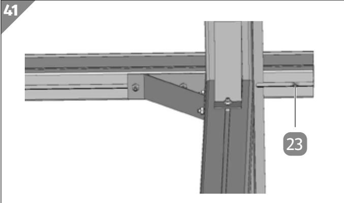
11. Setzen Sie an beiden Enden des Innenquerträgers eine M6×12-mm-Schraube **23** in den Schraubenkanal des Innenquerträgers ein. Folgen Sie dabei der Darstellung.
