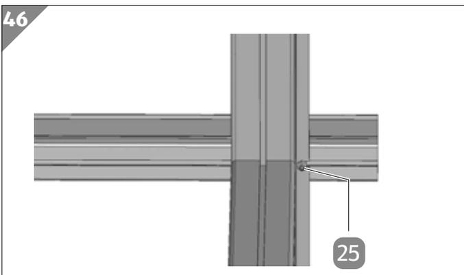
5. Verschrauben Sie den Innenquerträger und die Längsträger. Verwenden Sie hierfür eine M6-Mutter **25** pro M6×12-mm-Schraube.
