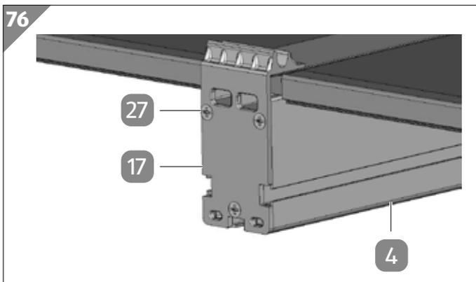
3. Setzen Sie eine Querträger-Abdeckkappe **17** auf das Ende eines der Innenquerträger **4**, welches noch nicht mit einer Querträger-Abdeckkappe versehen ist.
