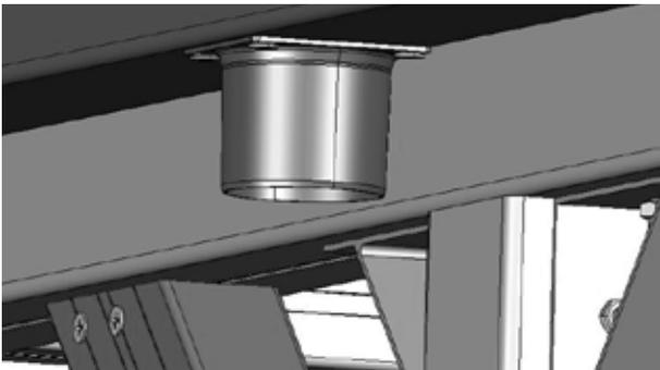
3. Verschrauben Sie den Ablaufstutzen mit der Regenrinne. Verwenden Sie dafür die gewindeformenden 4,8×13-mm-Blechschraben.
