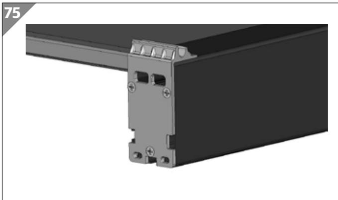
2. Verschrauben Sie die Querträger-Abdeckkappe und den Außenquerträger mithilfe von drei 4,2×22-mm-Blechschrauben **27**.
