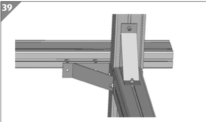
7. Verschieben Sie die zuvor eingesetzten M6×12-mm-Schrauben **23** so, dass sie exakt auf einer Linie mit den Durchgangslöchern der an den Pfosten befestigten Winkel **8** liegen.
