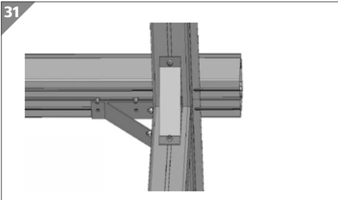
6. Verschieben Sie die zuvor eingesetzten M6×12-mm-Schrauben so, dass sie exakt auf einer Linie mit den Durchgangslöchern der an den Pfosten befestigten Winkel liegen.
