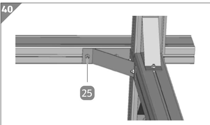
8. Setzen Sie den Innenquerträger vorsichtig auf die Winkel. Stellen Sie dabei sicher, dass die M6×12-mm-Schrauben durch die Durchgangslöcher der Winkel geführt sind.
