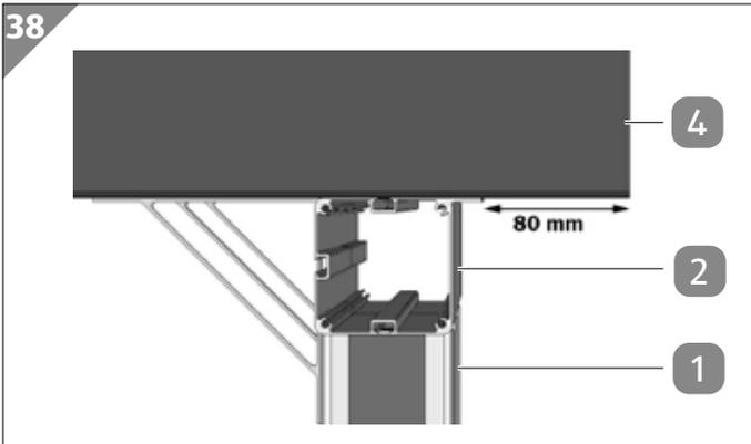
6. Richten Sie den Innenquerträger so aus, dass er auf beiden Seiten exakt 80 mm über die Überstände der Längsträger hinausragt.
