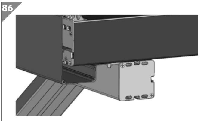
2. Verschrauben Sie die Längsträger-Abdeckung mit dem Längsträger. Verwenden Sie dafür zwei 4,2×22-mm-Blechschrauben (27).
