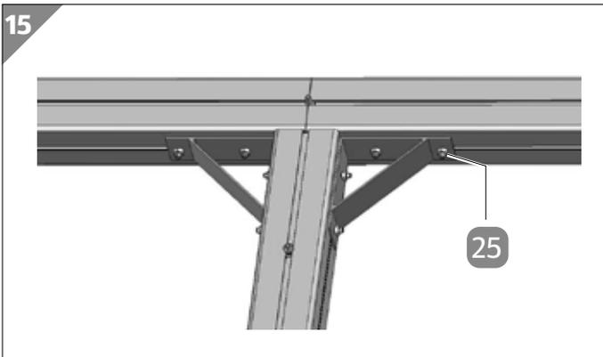
6. Richten Sie den Pfosten so aus, dass der Stoß der beiden Längsträger exakt auf einer Linie mit der Mitte des Schraubenkanals liegt.
