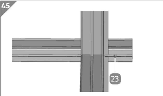
3. Setzen Sie an beiden Enden des Innenquerträgers eine M6×12-mm-Schraube **23** in den Schraubenkanal des Innenquerträgers ein. Folgen Sie dabei der Darstellung.
