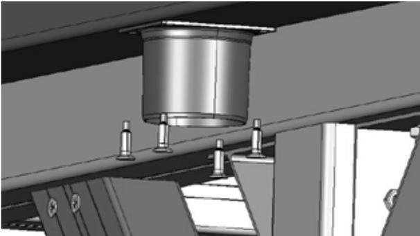
2. Setzen Sie den Ablaufstutzen an der dafür vorgesehenen Durchlassöffnung einer der Regenrinnen an. Achten Sie dabei darauf, dass der Durchlass des Ablaufstutzens exakt bündig mit der Durchlassöffnung der Regenrinne abschließt.
