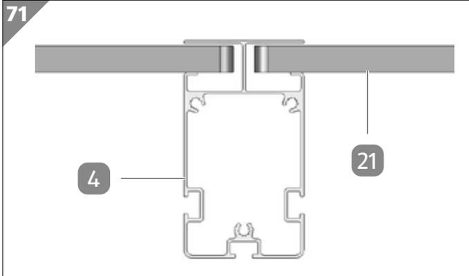
1. Setzen Sie die erste Doppelstegplatte **21** zwischen dem vorderen Außenquerträger **3** und dem dahinter liegenden Innenquerträger **4** ein. Schieben Sie die Doppelstegplatte dabei in die entsprechenden Nuten beider Querträger ein, wobei Sie die Doppelstegplatte bis zum Anschlag einschieben.
