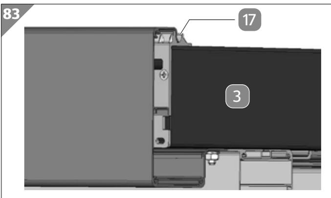
2. Richten Sie die Regenrinnen so aus, dass sie exakt bündig mit den Außenquerträgern **3** und den daran befestigten Querträger-Abdeckkappen **17** abschließen.
