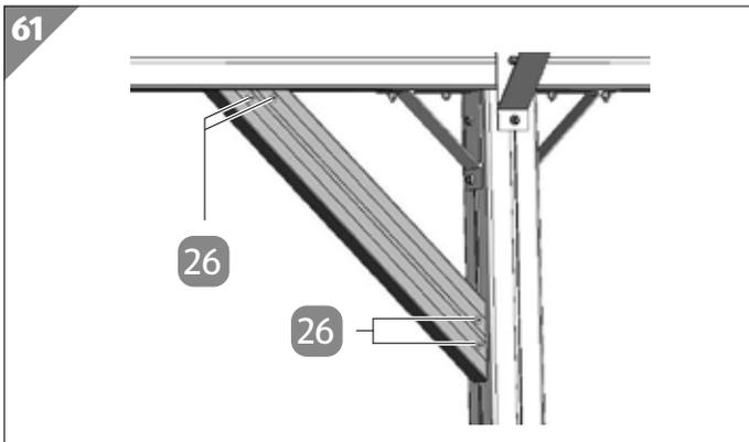
19. Befestigen Sie ein Kopfband **11**, indem Sie es in die Kopfbandaufnahme **12** am Pfosten sowie in die Kopfbandaufnahme an der Unterseite des Längsträgers einhängen.
