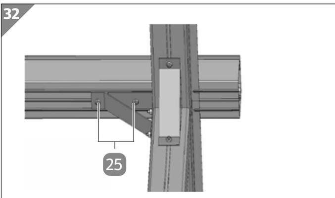
7. Setzen Sie den Koppelträger vorsichtig auf die Winkel. Stellen Sie dabei sicher, dass die M6×12-mm-Schrauben durch die Durchgangslöcher geführt sind.
