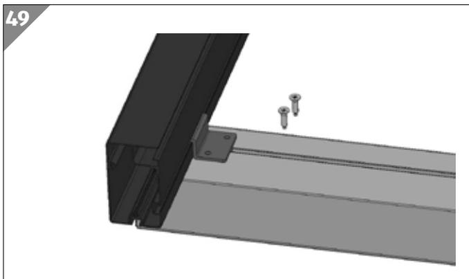
2. Schieben Sie den Sturmhaken bis zum Anschlag an den Außenquerträger. Achten Sie darauf, dass der Sturmhaken mit dem Außenquerträger abschließt.
