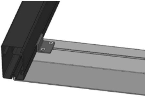
3. Verschrauben Sie den Sturmhaken mit dem Längsträger. Verwenden Sie hierfür zwei gewindeformende 4,8×13-mm-Blechschauben **26**. Schrauben Sie die Schrauben mithilfe eines Akkuschraubers **30** ein.
