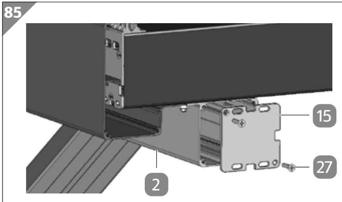
1. Setzen Sie eine der Längsträger-Abdeckungen (15) auf ein Ende eines der Längsträger (2).
