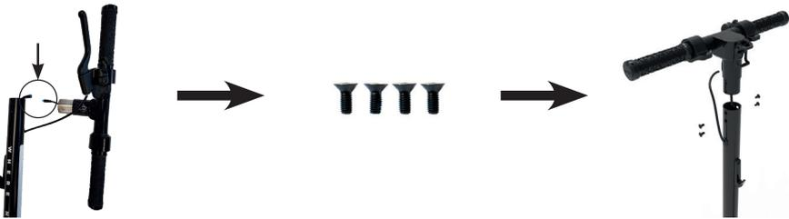
Verbinden Sie die Stecker des Steuerkabels und setzen dann die Lenkstange auf die Lenksäule. Verwenden Sie den Innensechskantschlüssel, um die Lenkstange mit den den 4 Schrauben zu fixieren.
