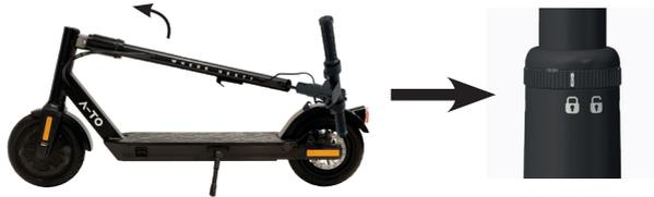
Richten Sie die Lenkstange auf, bis der Faltmechanismus einrastet. Sichern Sie diesen durch Drehen des Sicherungsringes, bis die Markierung auf das verriegelte Schloßsymbol zeigt.
