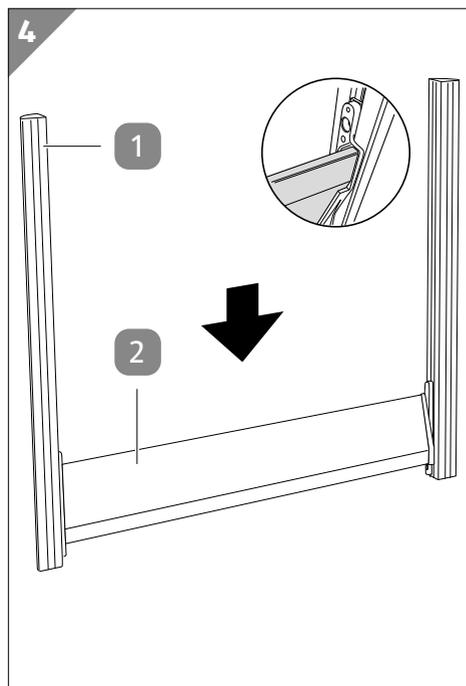
Im 4. Schritt werden die beiden in Schritt 2 vormontierten Eckpfosten über eine Aluminiumplanke miteinander verbunden.
