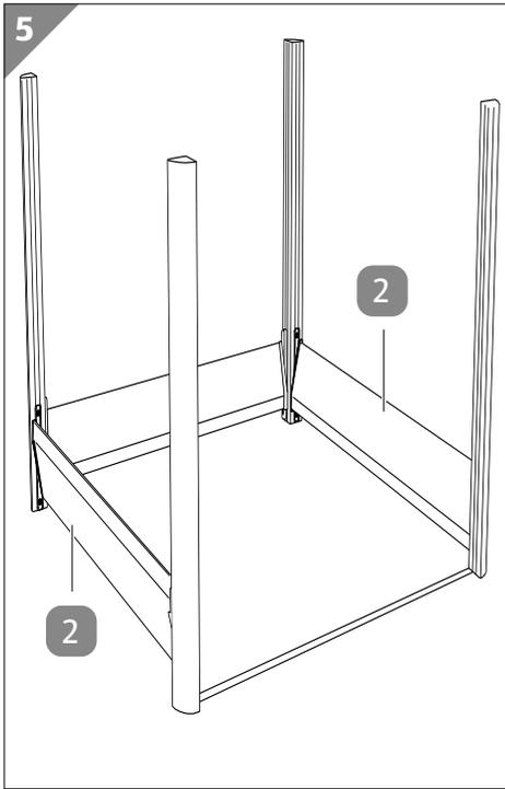
1. Richten Sie mithilfe einer zweiten Person die teilweise montierte Frontseite und die teilweise montierte Rückwand auf. Achten Sie darauf, dass die aufgerichteten Komponenten nicht umkippen.
