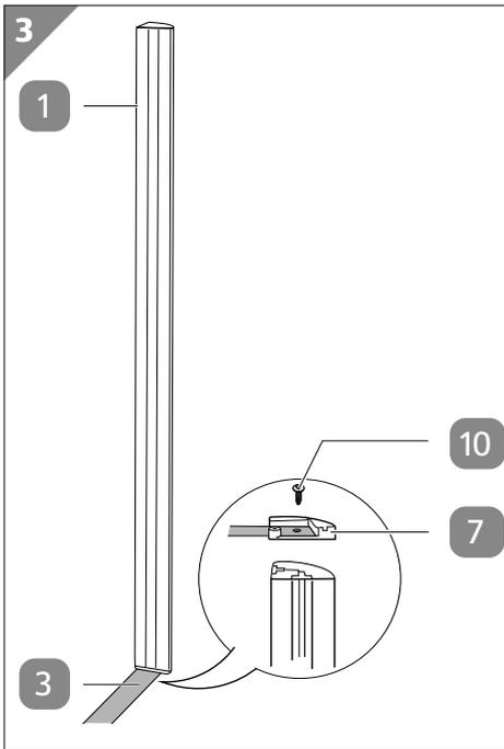
Im 3. Schritt werden die beiden verbleibenden Eckpfosten über die Querstrebe miteinander verbunden.
