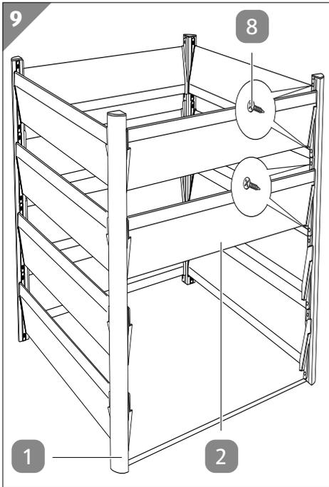
1. Nehmen Sie eine der beiden verbliebenen mit Steckprofilen **4** / **5** versehenen Aluminiumplanken **2**.
