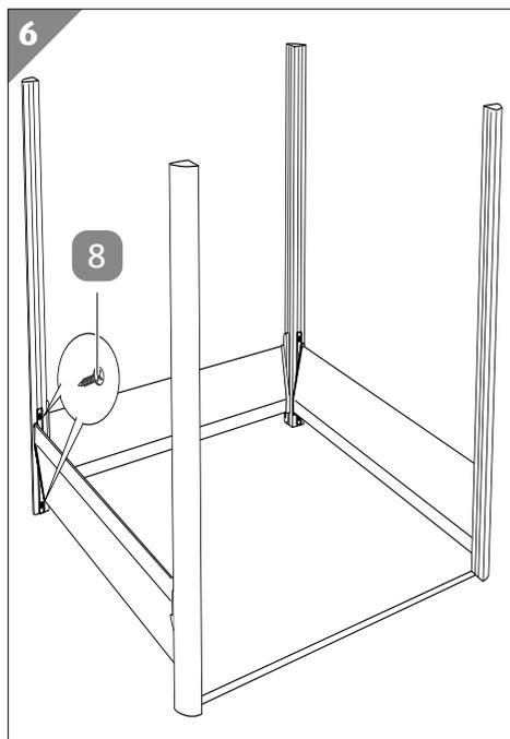
1. Verschrauben Sie eine der 3 bereits eingesetzten Aluminiumplanken (2) wie dargestellt mit den Eckpfosten (1). Verwenden Sie dazu auf jeder Seite zwei Senkkopfschrauben  $4,2 \times 16$  mm (8).
