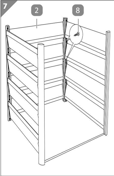
1. Nehmen Sie eine mit Steckprofilen **4**/**5** versehene Aluminiumplanke **2**.
