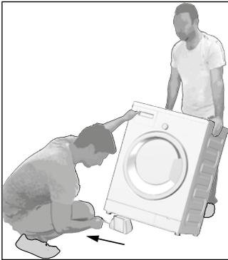
Die Waschmaschine ist bei Auslieferung mit einem Transportstabilisator versehen. Dieser muss vor dem Erstgebrauch entfernt werden. Gehen Sie dazu wie folgt vor:
