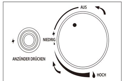
A. Drücken Sie die elektrische Zündung und halten Sie sie gedrückt. Drücken Sie gleichzeitig den Drehregler hinunter und drehen Sie ihn gegen den Uhrzeigersinn auf die Position NIEDRIG. Halten Sie den Drehregler weiter gedrückt, um den Gasbrenner anzuzünden.
