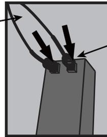
Vergewissern Sie sich, dass die Kabel vollständig in die Zündbox eingeführt sind.
