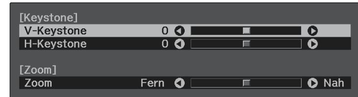
**3** Mit den Pfeiltasten an der Fernbedienung können Sie zwischen vertikaler und horizontaler Trapezkorrektur wählen und die Bildform wie erforderlich anpassen.
