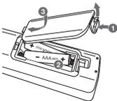
Nehmen Sie die Batterieklappe von der Rückseite der Fernbedienung ab und legen Sie die Batterie mit der richtigen Polung **+** und **-** ein.
