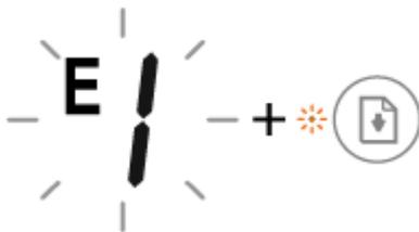
Vom Drucker wird ein Druckauftrag empfangen. Er beginnt, Papier zuzuführen und erkennt dann, dass die für den Auftrag ausgewählte Papierbreite die Breite des eingelegten Papiers überschreitet.
