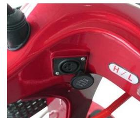
Stecken Sie das Ladekabel des Ladegeräts in den Ladeanschluss an der Konsole des Elektromobils. Danach stecken Sie das Netzkabel des Ladegeräts in die Steckdose.
