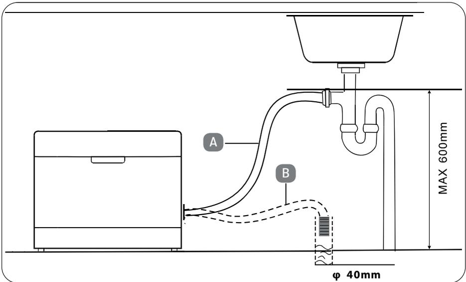
Sie können den Abflussschlauch auf unterschiedliche Weise anschließen:
