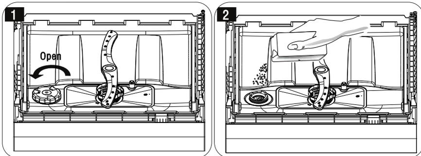
1. Entfernen Sie den Geschirrkorb und drehen Sie den Deckel vom Regeneriersalzbehälter ab.
