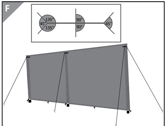
11. Schlagen Sie den Hering **6** mit einem Gummihammer so in den Boden, dass der Hering in einem etwa  $45^\circ$  großen Winkel zum Boden liegt (s. Abb. G).
