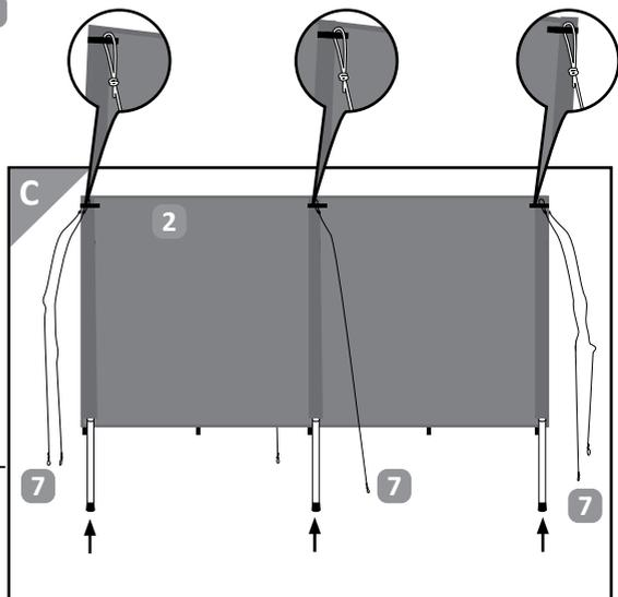
7. Stellen Sie eine der äußeren Stangen so auf, dass das geschlossene Ende der Ösen nach oben ausgerichtet ist und in einem  $90^\circ$ -Winkel zum Boden platziert ist (s. Abb. D).
