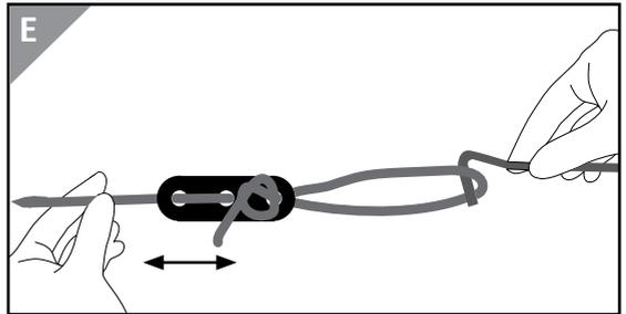
10. Ziehen Sie die Schnur stramm. Die Schnur sollte in einem  $135^\circ$ -Winkel zum Windschutz platziert sein (s. Abb. F)
