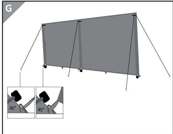
durch die Schlaufe am unteren Ende des Windschutzes. Der Hering sollte in einem  $45^\circ$ -Winkel zum Boden liegen (s. Abb. G).
