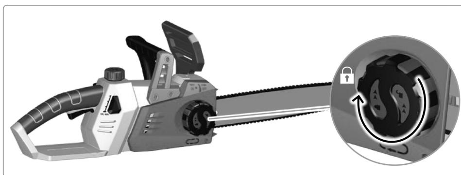
A láncfeszesség növelése érdekében fordítsa el a láncfeszítés beállító csavarját az óramutató járásával megegyező irányba, közben rendszeresen ellenőrizze a láncfeszességet. A láncfeszesség csökkentése érdekében fordítsa el a láncfeszítés beállító csavarját az óramutató járásával ellentétes irányba, közben rendszeresen ellenőrizze a láncfeszességet.
