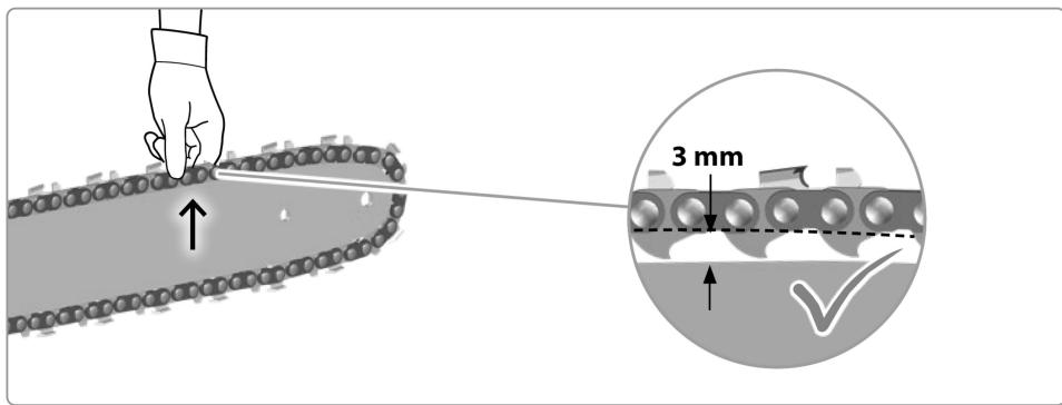
La tension de la chaîne est correcte lorsque la distance entre les dents de la chaîne et le guide est d'environ 3 mm. Tirez la chaîne au bas du guide au milieu vers le bas (loin du guide) et mesurez ensuite la distance entre le guide et la chaîne. Serrer les écrous de montage de la barre (figure 4) et les tourner dans le sens horaire.
