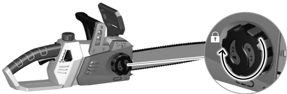
Um die Kettenspannung zu erhöhen, drehen Sie die Einstellschraube für die Kettenspannung im Uhrzeigersinn, überprüfen Sie dabei regelmäßig die Kettenspannung. Um die Kettenspannung zu verringern, drehen Sie die Einstellschraube gegen den Uhrzeigersinn, prüfen Sie dabei regelmäßig die Kettenspannung.
