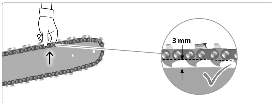
La tensione della catena è corretta quando lo spazio tra i denti della catena e la guida è di ca. 3 mm. Tirare la catena sul lato inferiore della guida al centro verso il basso (allontanandola dalla guida), dopodiché misurare la distanza tra la guida e la catena. Serrare i dadi di fissaggio della barra (fig. 4) ruotandolo in senso orario.
