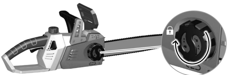
Afin d'augmenter la tension de la chaîne, tourner la vis de serrage dans le sens horaire et vérifier fréquemment la tension de la chaîne. Afin de réduire la tension de la chaîne, tourner la vis dans le sens antihoraire et vérifier fréquemment la tension de la chaîne.
