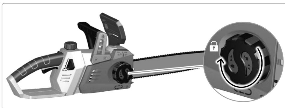
Per aumentare la tensione della catena, ruotare la manopola di regolazione del tensionatore della catena in senso orario e controllare frequentemente la tensione della catena. Per ridurre la tensione della catena, ruotare la manopola di regolazione del tensionatore catena in senso antiorario e controllare frequentemente la tensione della catena.
