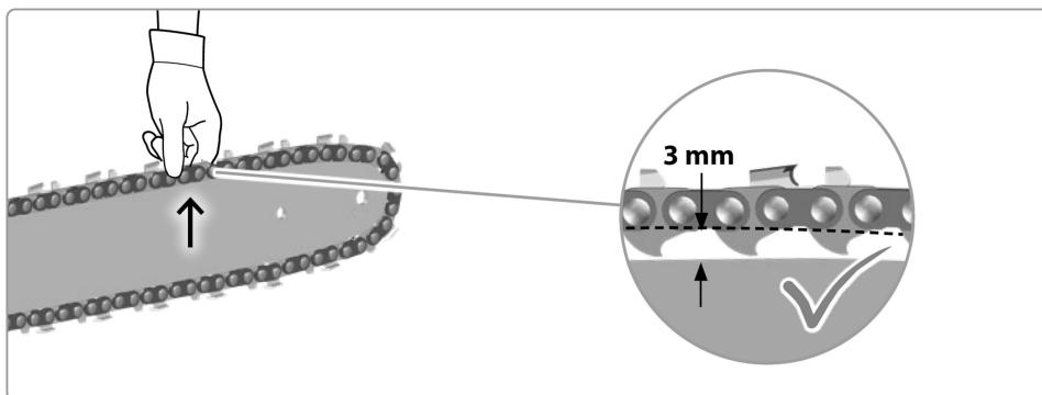
Die Kettenspannung ist richtig eingestellt, wenn der Abstand zwischen den Zähnen der Kette und des Schwertes ca. 3 mm beträgt. Ziehen Sie die Kette an der unteren Seite des Schwertes in der Mitte nach unten (von der Schiene weg) und messen dann den Abstand zwischen dem Schwert und der Kette. Ziehen Sie die Befestigungsschrauben für das Schwert im Uhrzeigersinn fest.
