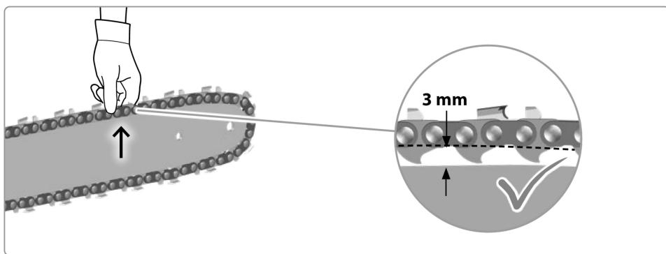
A láncfeszesség akkor van helyesen beállítva, ha a lánc és fűrészlap fogai közötti távolság kb. 3 mm. Húzza a láncot a fűrészlap alsó oldalánál középen lefelé (a láncvezetőtől el) és mérje meg a fűrészlap és a lánc közötti távolságot. Szorítsa meg a fűrészlap rögzítőcsavarját az óramutató járásával megegyező irányba.
