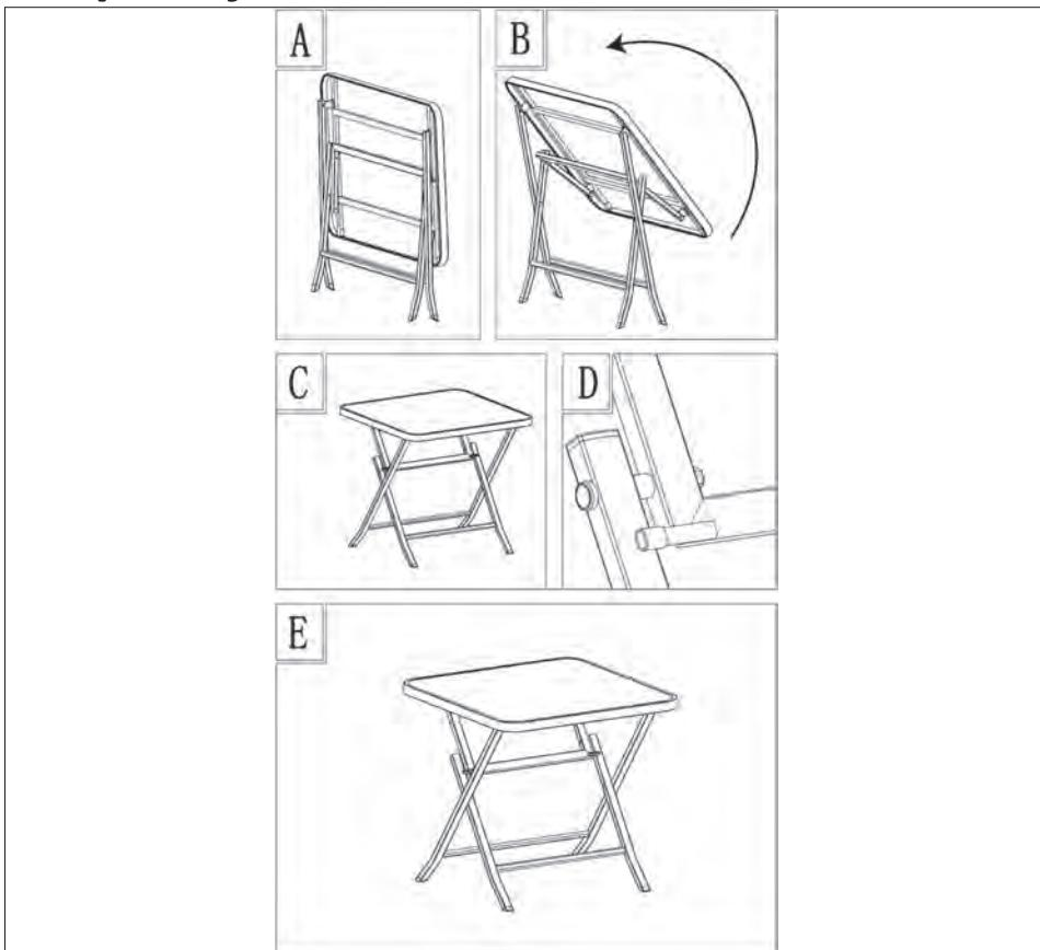
Mizno ploščo zložene mize primite za spodnji rob mize in povlecite navzgor, dokler se miza povsem ne razpre (**glejte slike A–E**).
