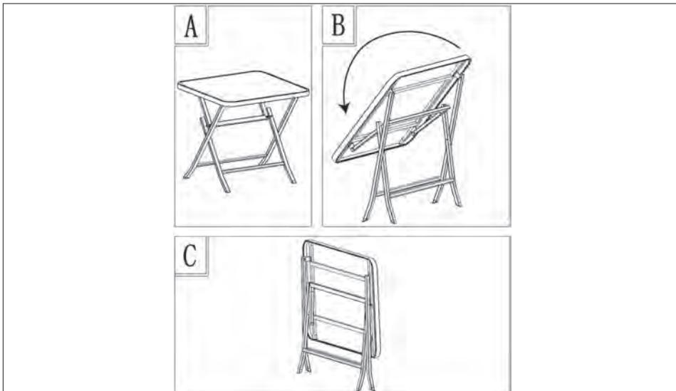
Mizno ploščo primite na strani togih nog mize in povlecite navzgor, dokler se miza povsem ne zloži (**glejte slike A–C**).
