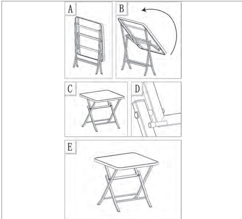
Greifen Sie die Tischplatte des zusammengeklappten Tisches an der unteren Tischkante und ziehen Sie diese nach oben bis der Tisch vollständig ausgeklappt ist (**s. Abbildungen A–E**).
