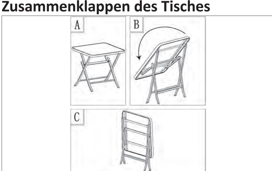
Greifen Sie die Tischplatte an der Seite des durchgehenden, starren Tischbeins und ziehen Sie sie nach oben bis der Tisch vollständig zusammengeklappt ist (s. Abbildungen A–C).
