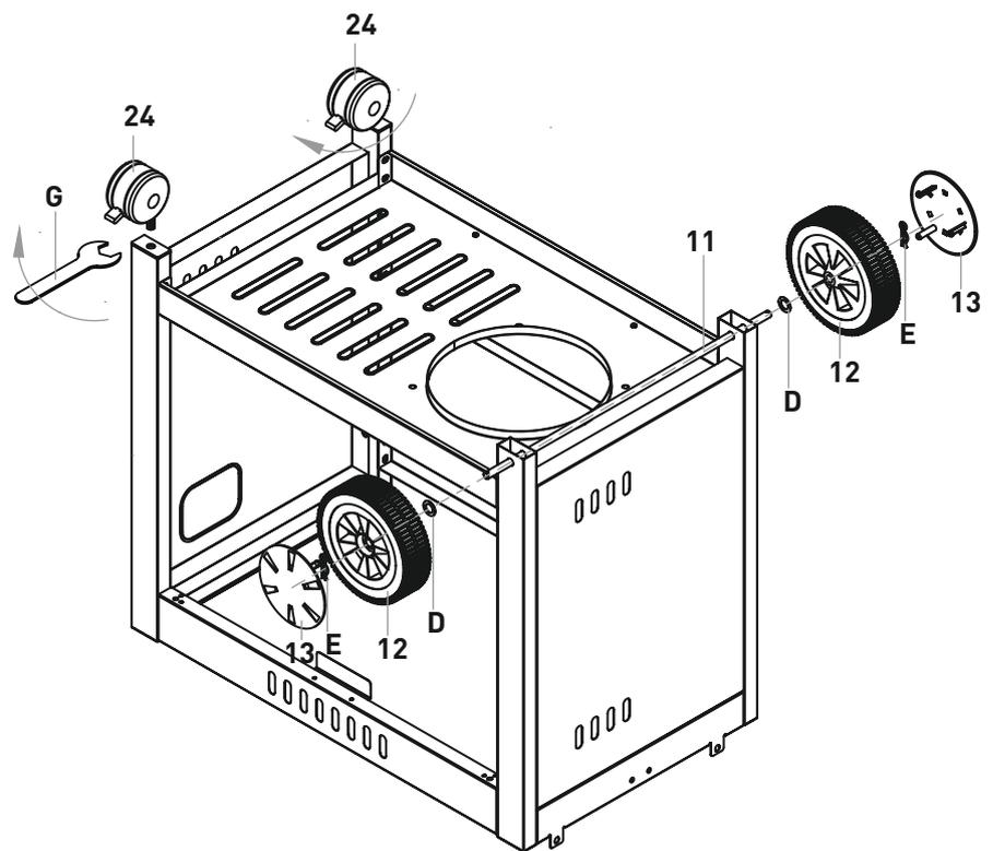
Rollen mit dem Maulschlüssel (D) nach dem Einschrauben festziehen.
