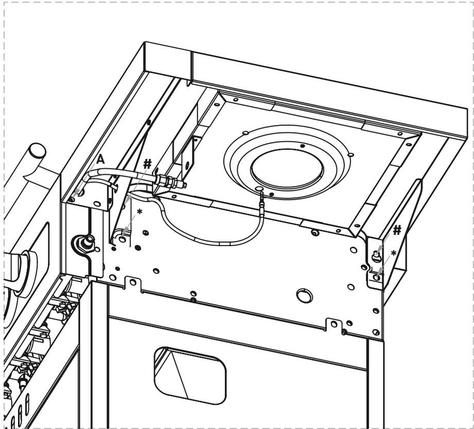
Entfernen Sie die Mutter von der Düse, stecken Sie sie durch das Loch der Halterung und fixieren Sie die Düse mit der Mutter, wie dargestellt.
