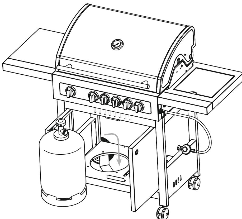
Gasflaschen mit einem maximalen Maß von  $\varnothing 24 \times 48$  cm können verwendet und in dem Grill aufgestellt werden. Größere Flaschen können nur neben dem Grill platziert werden.
