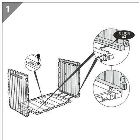
1. Legen Sie die Bodenplatte **2** mit der Innenseite nach oben auf eine weiche Unterlage.
