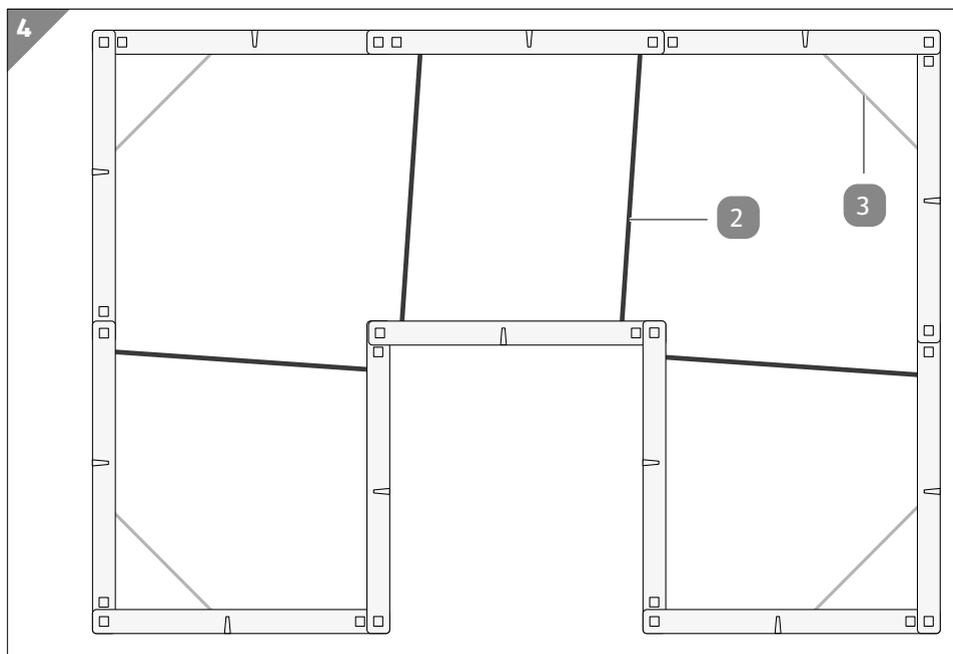
Das Produkt ist über die Distanzrohre **2** und die Distanzbügel **3** stabilisiert.
