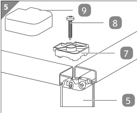
3. Schrauben Sie je eine Klemmplatte **7** mit einer Schraube **8** oben auf jedem Ecksteher **5** fest.
