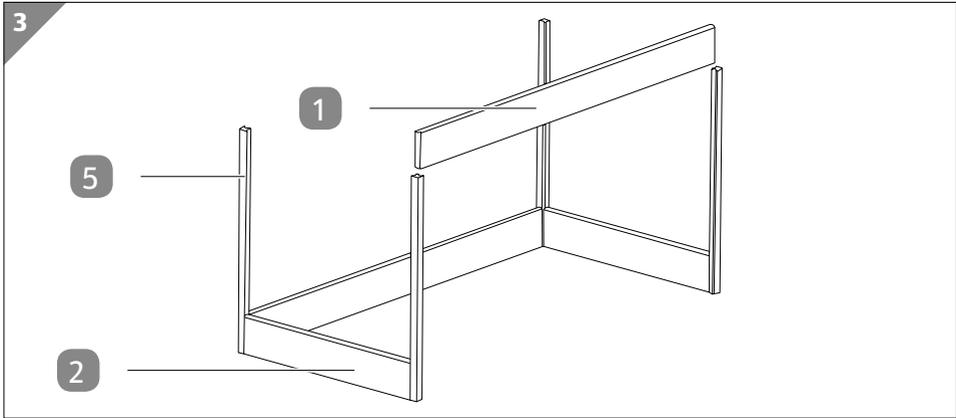
1. Schieben Sie eine lange bzw. kurze Planke **1** und **2** zwischen die Ecksteher **5**, bis Sie ein Rechteck geformt haben.
