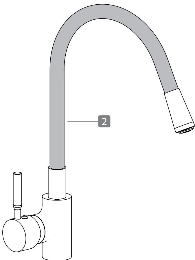
A kifolyó **2** kis mértékben minden irányban (forgatási tartomány  $360^\circ$ ) forgatható és hajlítható.
