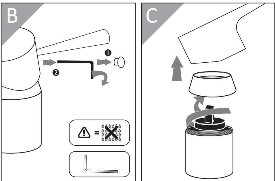
Austausch der Kartusche / Remplacement de la cartouche / Sostituzione delle cartucce
