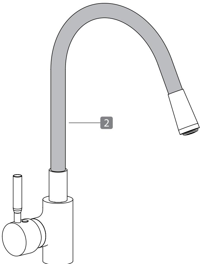
Der Auslauf 2 kann sanft in alle Richtungen (Schwenkbereich 360°) geschwenkt und gebogen werden.
