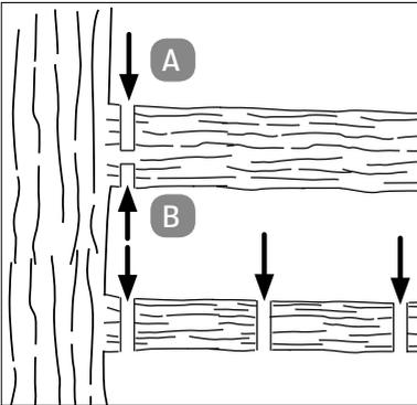
1. Sägen Sie zuerst mit der Oberseite des Sägegeschwertes **14** von unten nach oben  $\frac{1}{3}$  des Astdurchmessers durch **B**.
