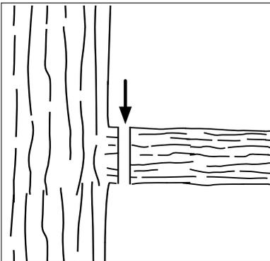
1. Legen Sie die Anschlagfläche des Sägeschwertes **14** am Ast an. Dies vermeidet ruckartige Bewegungen des Hochentasters beim Beginn des Schnittes.
