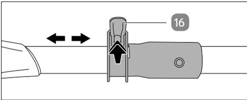
1. Öffnen Sie die Teleskopstangen-Verriegelung **16**.
