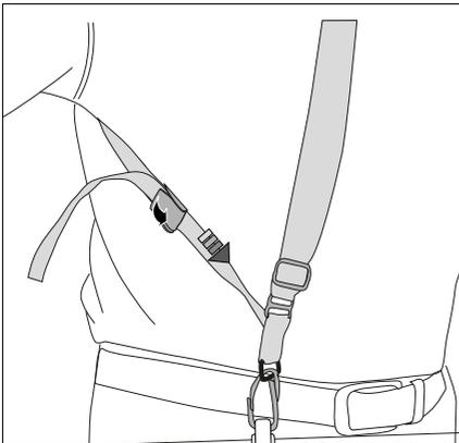
3. Um den Hochentaster im Notfall schnell abzulegen, klappen Sie den Verschluss der Entriegelungs-Schnalle mit dem Daumen auf.
