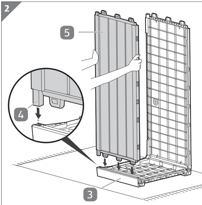
1. Stecken Sie die zweite Wand **5** in das Seitenteil **3**. Achten Sie darauf, dass dabei die Metallschiene **4** wie abgebildet in die Aussparung eingeführt wird. Die Wand rastet mit einem Klick ein.
