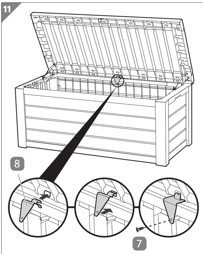
1. Stecken Sie die Deckelführung **8** durch die mittlere Aussparung im Deckel **1** und haken Sie die Deckelführung in der Wand **5** ein.
