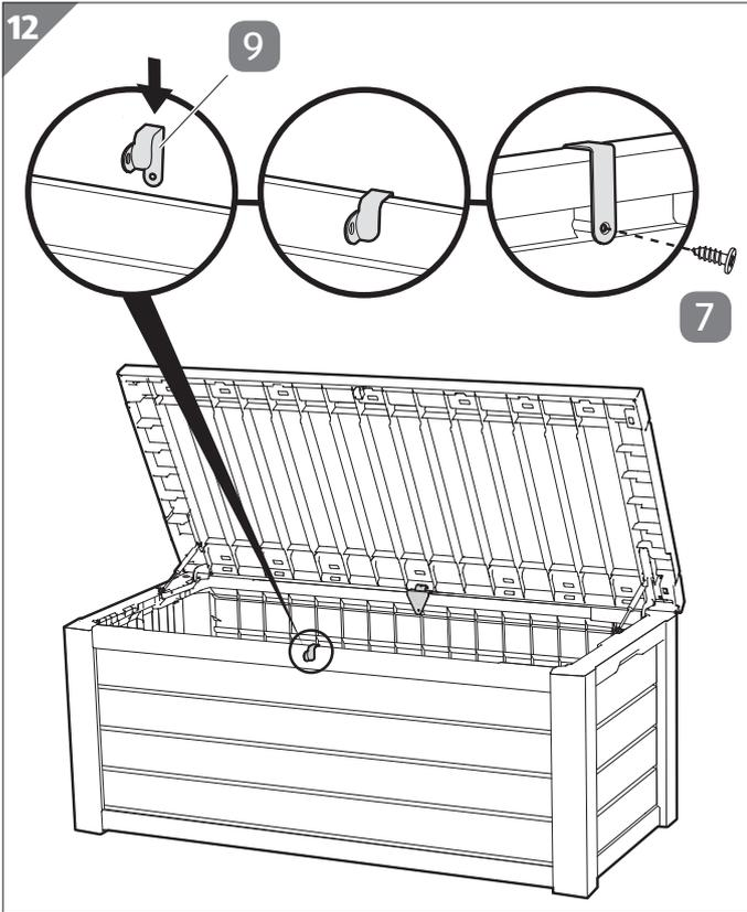
1. Setzen Sie den Überfall, rechts **9** mittig über der vorderen Wand **5** ein.
