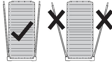
1. Halten Sie die beiden Wände **5** leicht auseinander und fügen Sie die Bodenplatte **6** dazwischen ein.
