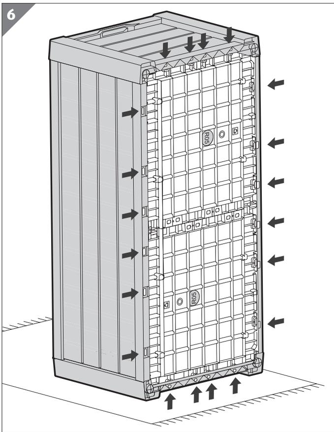
1. Drücken Sie die Seitenteile **3** und Wände **5** in Richtung Bodenplatte **6**.
