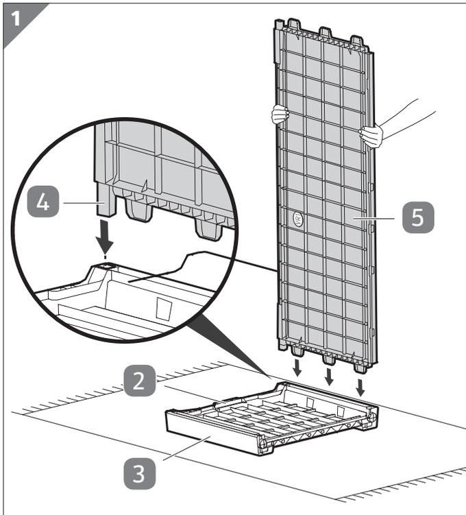
1. Legen Sie ein Seitenteil **3** auf eine weiche Unterlage. Die Innenseite des Seitenteils zeigt nach oben. Der Griff **2** befindet sich links.
