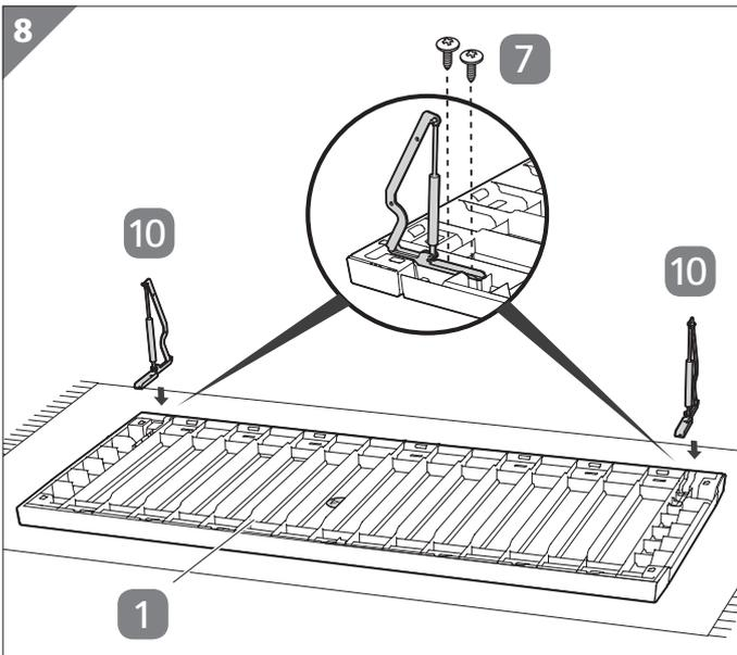
1. Klappen Sie die Hydraulikscharniere **10** auf.
