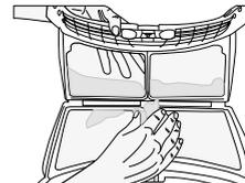
4. Saugen Sie Flusen im Flusensiebeinschub mit einem Staubsauger ab.
