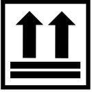
Der Trockner muss immer so transportiert werden, dass die Pfeile nach oben zeigen.
