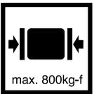
Der Trockner kann an den entsprechenden Stellen mit maximal 800 kg-f geklemmt werden.
