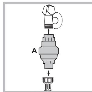
1. Avvitare il dispositivo "Water Block" (A) su un rubinetto dell'acqua fredda con il raccordo filettato e avvitare il tubo dell'acqua al dispositivo.
