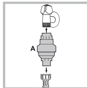
1. Visser l'appareil "Water Block" (A) sur un robinet d'eau froide avec la connexion filetée et visser le tuyau d'eau à l'appareil.
