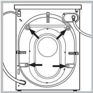
3. Die 4 Transportschutzschrauben ausschrauben und das an der Rückwand befindliche Gummiteil und das entsprechende Abstandsstück abnehmen (siehe Abbildung).
