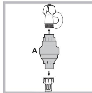
1. Schrauben Sie die Vorrichtung „Water Block“ (A) an einen Kaltwasserhahn mit 3/4-GAS-Gewindeanschluss an und schrauben Sie dann den Wasseranschlauch an die Vorrichtung.
