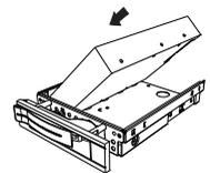
Achten Sie darauf, dass sich die beiden kleinen Haken des Wechselrahmens in die Schraublöcher der Festplatte schieben. Lassen Sie dann die Festplatte vorsichtig komplett in den Wechselrahmen gleiten.
