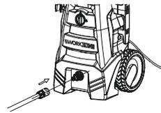
6. Verbinden Sie den Zulaufschlauch mit einer Schnellverschluss-Kupplung (nicht im Lieferumfang enthalten) mit dem Adapter für den Wasserzulauf am Hochdruckreiniger (siehe **Abb. 6**).
