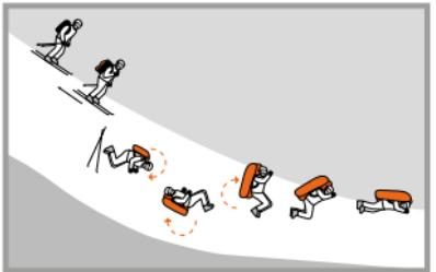
Il volume supplementare degli airbags di 170 litri complessivi fa in modo che si rimanga sulla superficie della massa nevosa. Qui contribuiscono anche la forma ed il montaggio degli airbags. Una grossa superficie, unita ad un fissaggio flessibile ed anatomico traducono ottimamente le forze di scorrimento. Il sistema airbag da valanga ABS ha preservato già centinaia di appassionati di sport invernali da un seppellimento e non pochi gli devono la vita.
