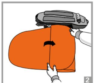
2. Repliez la partie supérieure de l'airbag à la hauteur de la poche airbag.
