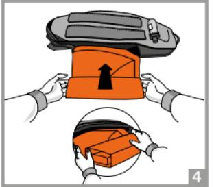
5. Schieben Sie nun die Airbags in die dafür vorgesehenen Seitentaschen. Die Füll- und Ablasseinheit muss nach der Faltung sichtbar oben auf dem Airbagmaterial liegen.
