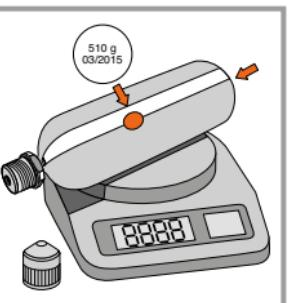
**Eine vollständig gefüllte Patrone ist absolute Voraussetzung für das Funktionieren des ABS-Lawinenairbags.**
