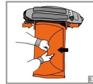
3. Falten Sie nun den unteren Teil des Airbags. Die Airbagbreite muss der Breite der Airbagtasche entsprechen.
