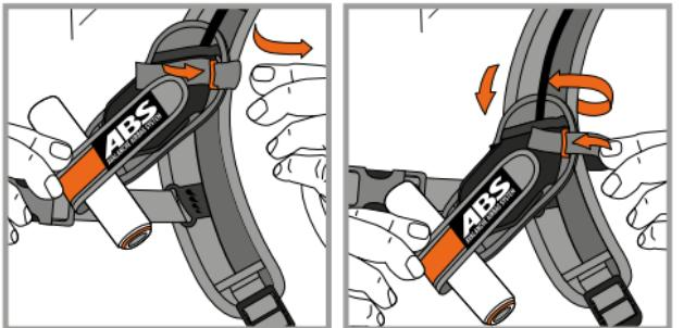
Per regolare l'altezza, aprire la chiusura a strappo e sfilarla, quindi sfilare l'occhiello in plastica e regolare la posizione in alto o in basso infilando la cinghietta in tessuto. Fissare la sede della maniglia nell'occhiello riposizionato, infilare la chiusura a strappo e chiudere.
