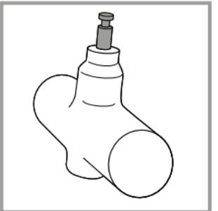
**Si la bague rouge est visible sur la tige, la poignée n'est plus chargée et ne peut plus fonctionner!**
