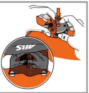
Soulevez ensuite le cache de protection rouge et appuyez sur le bouton de purge qui se situe au centre de la valve de remplissage et de purge de couleur noire. Dans le même temps, exercez une pression sur l'airbag, jusqu'à ce que celui-ci soit totalement dégonflé.
