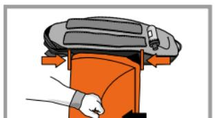
3. Repliez ensuite la partie inférieure de l'airbag. La largeur de l'airbag doit être égale à celle de la poche airbag.
