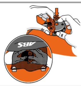
Staccate innanzitutto la rete di protezione sull'unità di scarico e riempimento.
