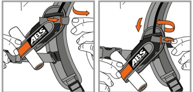
Zur Höhenverstellung Klettverschluss öffnen und ausfädeln, dann Kunststofföse ausfädeln und eine Position weiter oben oder unten wieder durch den kleinen Stoffriemen einfädeln. Griffplatte nun wieder auf die neu positionierte Öse aufstecken, Klettverschluss wieder einfädeln und schließen.
