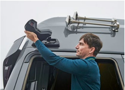
Die Haltearme sind in zwei Richtungen klappbar
