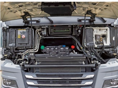
Kühlwasser und Öl hinter der Frontklappe
