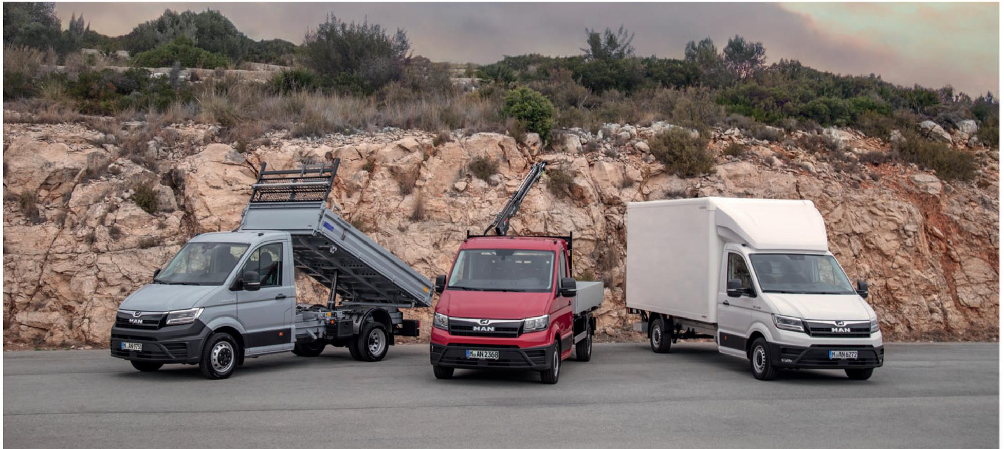
1 – Dreiseitenkipper; 2 – Leichtbaukoffer; 3 – Servicefahrzeug mit Regalausbau;
