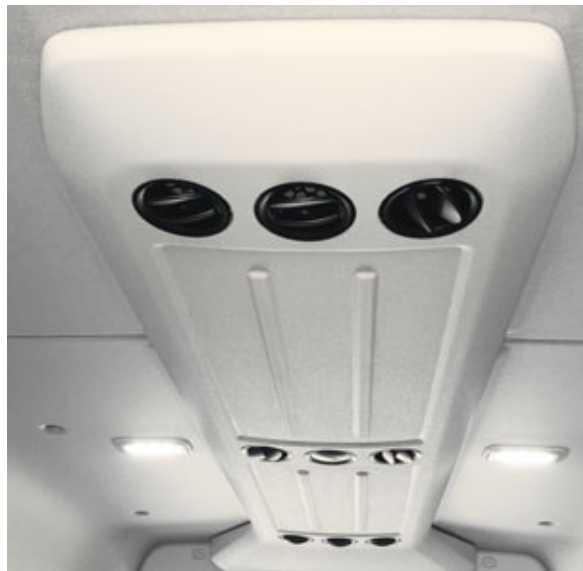
Komforthimmel mit Lüftungskanal 1 im MAN TGE Kombi
