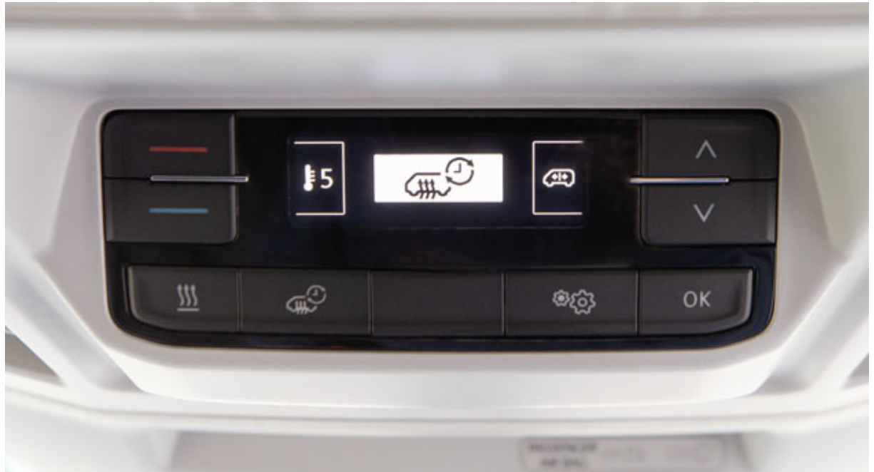
Bedieneinheit des MAN TGE Kombi für die Standheizung 1
