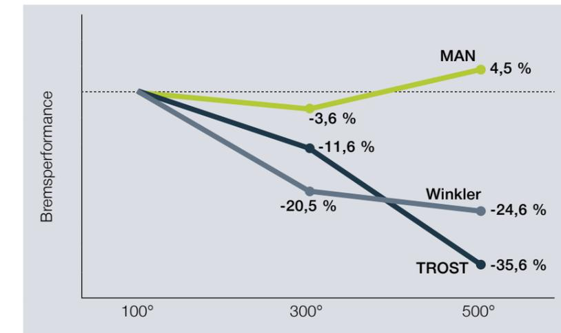
Der MAN Original Bremsbelag überzeugt bei Temperaturanstieg durch das konstanteste Bremsmoment. Die größte Abweichung beträgt lediglich 4,5 %.
