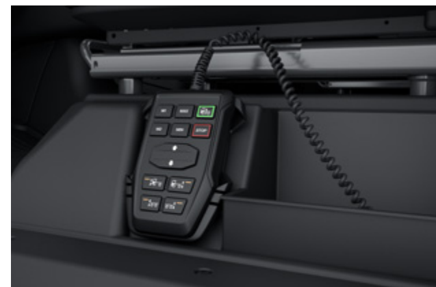
Control de la suspensión neumática del vehículo (VASC)
