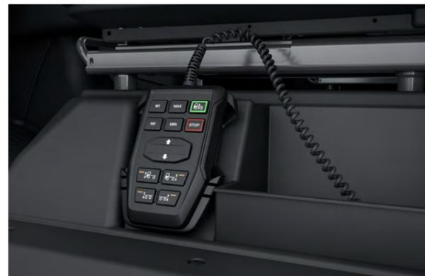
Unité de commande pour suspension pneumatique à régulation électronique (VASC)
