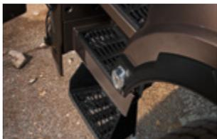
El peldaño inferior, propenso a sufrir daños en los trayectos todoterreno, ahora viene equipado con una función de péndulo. Los soportes de montaje están hechos de un plástico elástico que se deforma al tocar el suelo y enseguida recupera su forma original.
