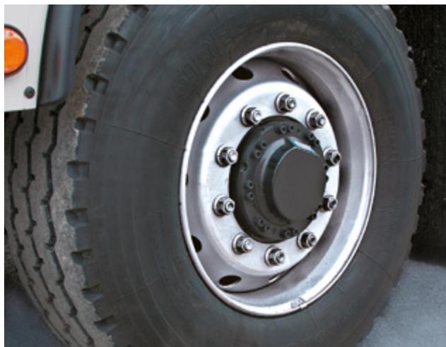
Eje delantero con motor hidrostático en el cubo de la rueda
