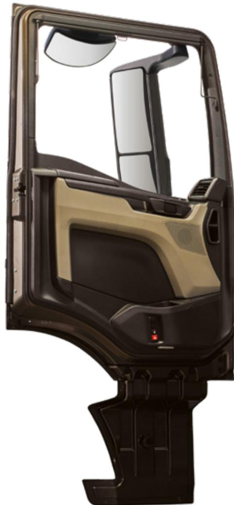
**Avec son angle d'ouverture de porte très large de 89° et un emmarchement très bas, le MAN TGS permet une montée à bord et une descente ergonomiques sur les parkings comme sur les chantiers.**
