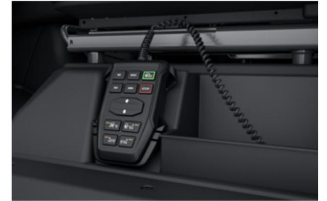
Unité de commande pour suspension pneumatique à régulation électronique (VASC)
