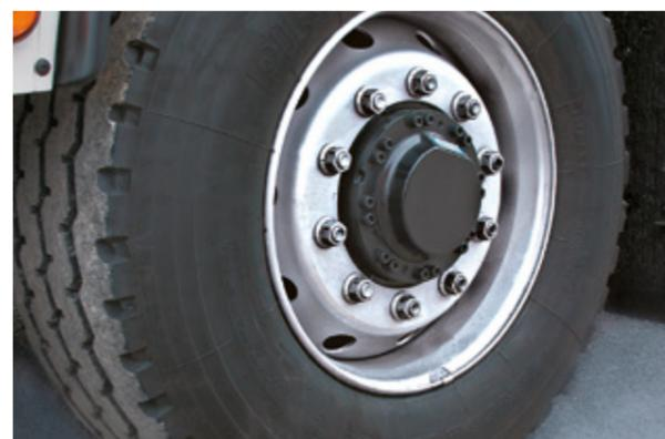
Essieu avant avec moteurs-roues hydrostatiques
