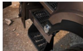
La dernière marche susceptible d'être endommagée lors des trajets sur terrains accidentés est désormais équipée d'une fonction de bascule. Les languettes de fixation sont en matière plastique élastique, elles se déforment au contact du sol et reprennent ensuite leur forme d'origine.
