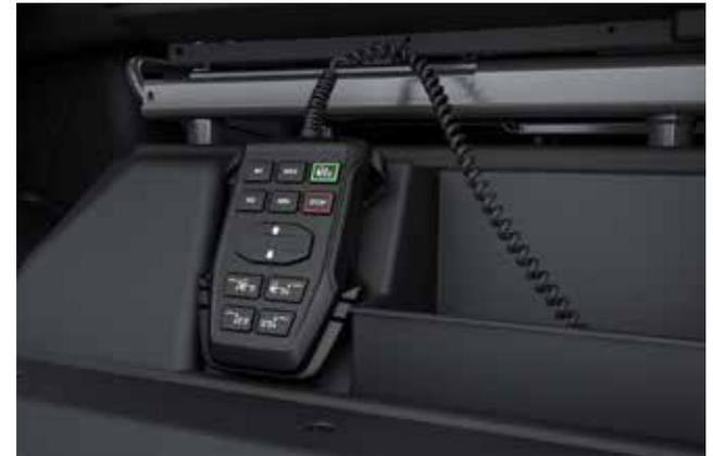
Bedieneinheit für elektronisch geregelte Luftfederung (VASC)
