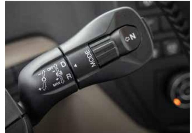
**Fahrbereichswahl für MAN TipMatic® am Lenkstockschalter.** Vollständig neu entwickelt wurde die Getriebebedienung am rechten Lenkstock. Sowohl Fahrbereich als auch Fahrprogramm werden am Lenkstockschalter gewählt. Die Bedienung erfolgt griffgünstig und bediensicher in unmittelbarer Nähe des Lenkrads und der elektrischen Feststellbremse.
