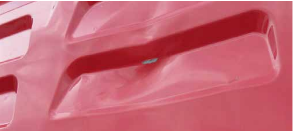
✗ Deformation an der Fahrerhausrückseite
