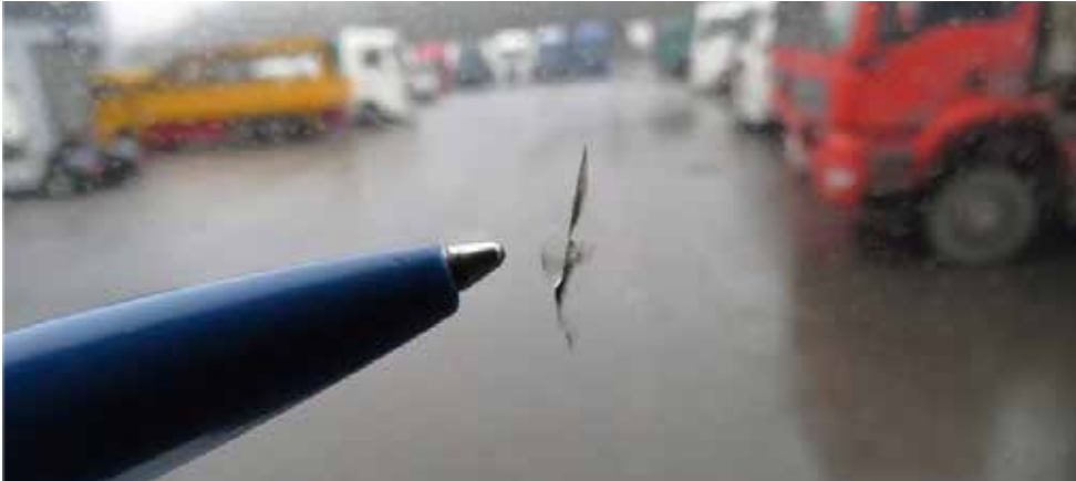
✗ Steinschlag mit Rissbildung im Sichtfeld
