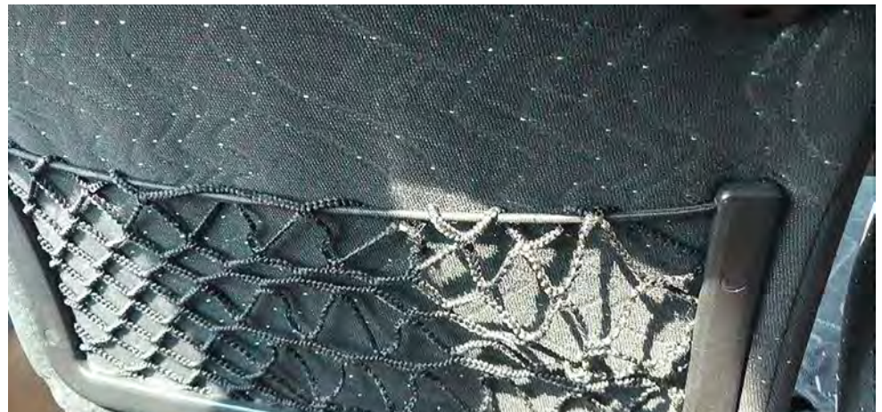
✗ Sitznetz gerissen oder provisorisch instandgesetzt
