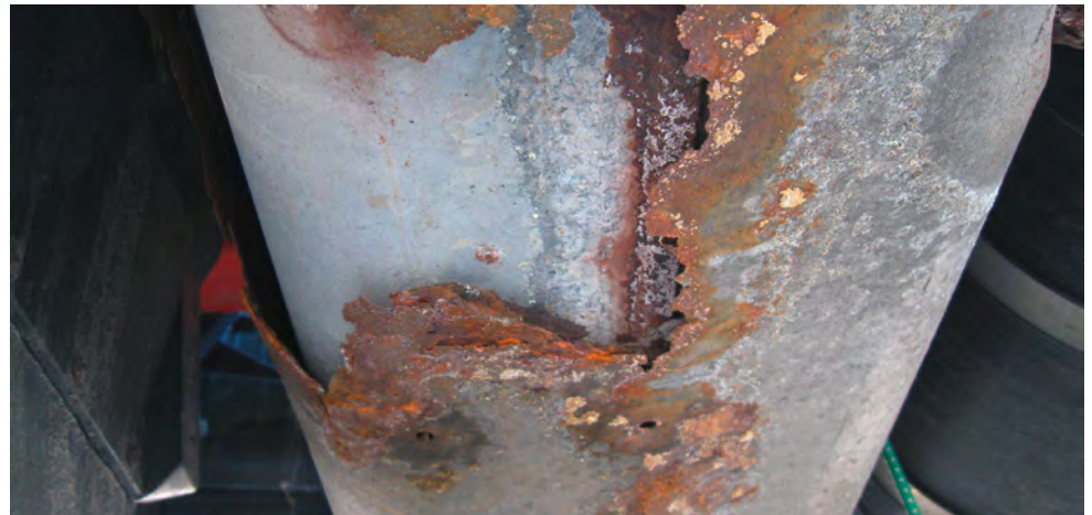
✗ Starke Durchrostung des Endschalldämpfers.
