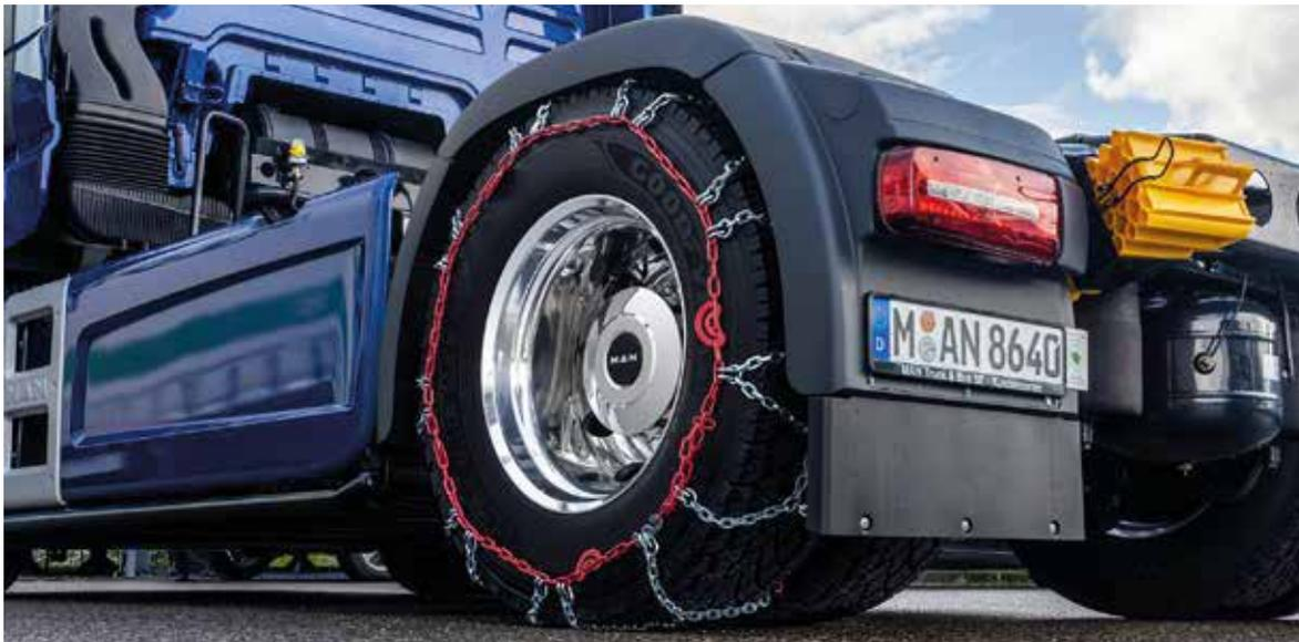
As correntes de neve para camiões e autocarros são feitas de aço endurecido de 5,5 ou 7 mm. Estas correntes proporcionam uma tração e estabilidade inigualáveis no gelo e na neve. A sua estrutura robusta e os materiais de alta qualidade com proteção contra corrosão tornam-nas duradouras e fiáveis mesmo em condições extremas.
