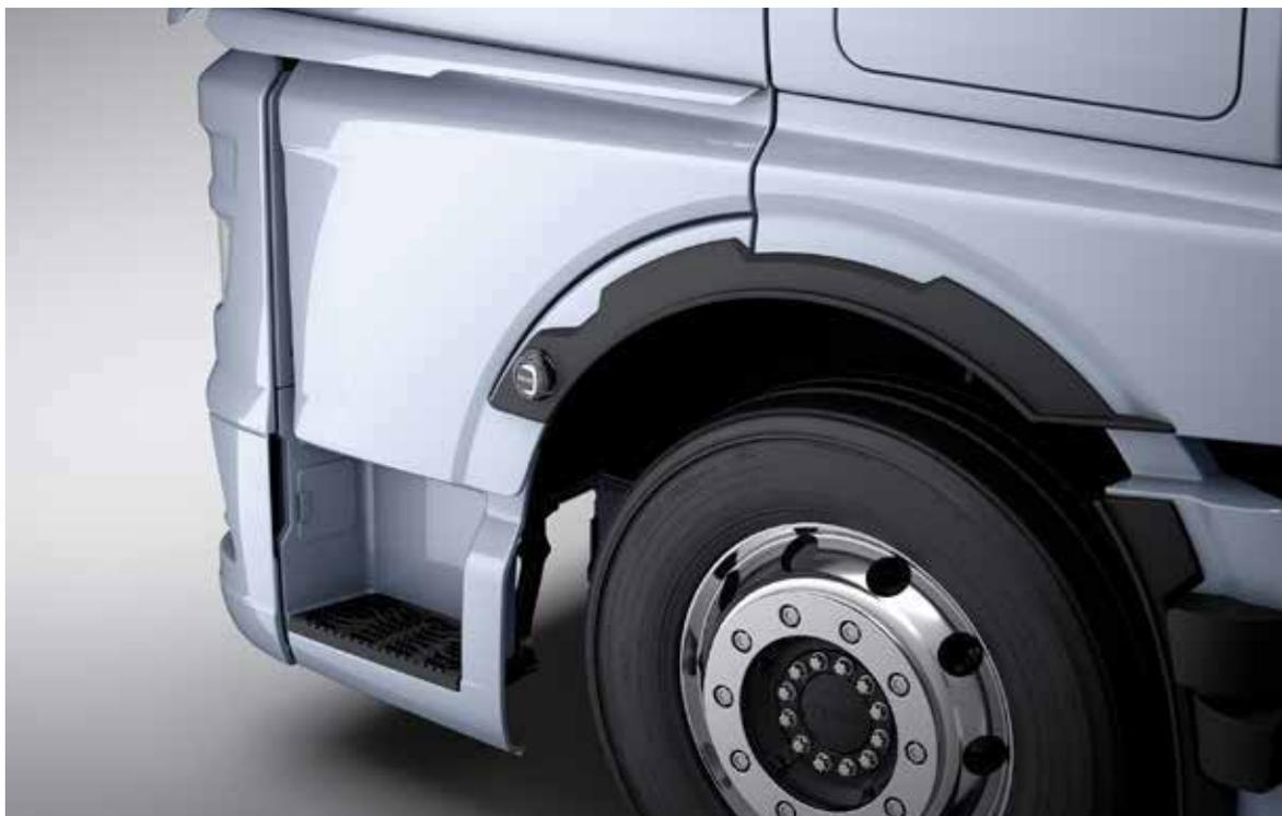
Este revestimento de plástico resistente aos danos, fixado na parte inferior das portas, melhora o fluxo aerodinâmico do veículo, reduzindo assim o consumo de combustível. Além disso, a área de entrada fica menos suja e não está exposta às intempéries. O veículo ganha em estética e o condutor fica protegido contra escorregamentos em degraus com gelo ou sujos. Além disso, os degraus ocultos tornam o acesso à cabina mais difícil, protegendo assim contra o roubo.
