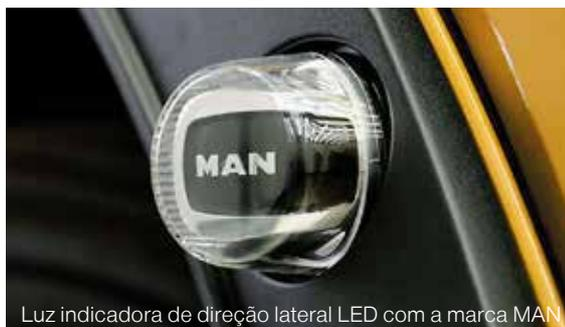
Luz indicadora de direção lateral LED com a marca MAN
