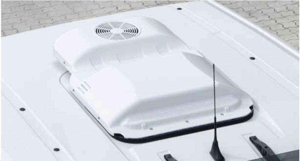
Graças à estrutura especial em duas partes, o sistema de ar condicionado de tejadilho para camiões pode ser instalado por baixo do spoiler de tejadilho, tornando-o particularmente adequado para os modelos MAN TGX com a cabina GM ou XLX (altura média) e spoiler de tejadilho. O MAN Cooltronic G2.5 também pode ser usado em todos os outros veículos MAN TG com cabina longa.
